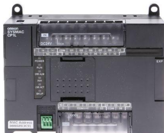
Figura 27. Autómata Programable serie CP1L-EL20DT1-D Fuente: (OMRON, 2015)
