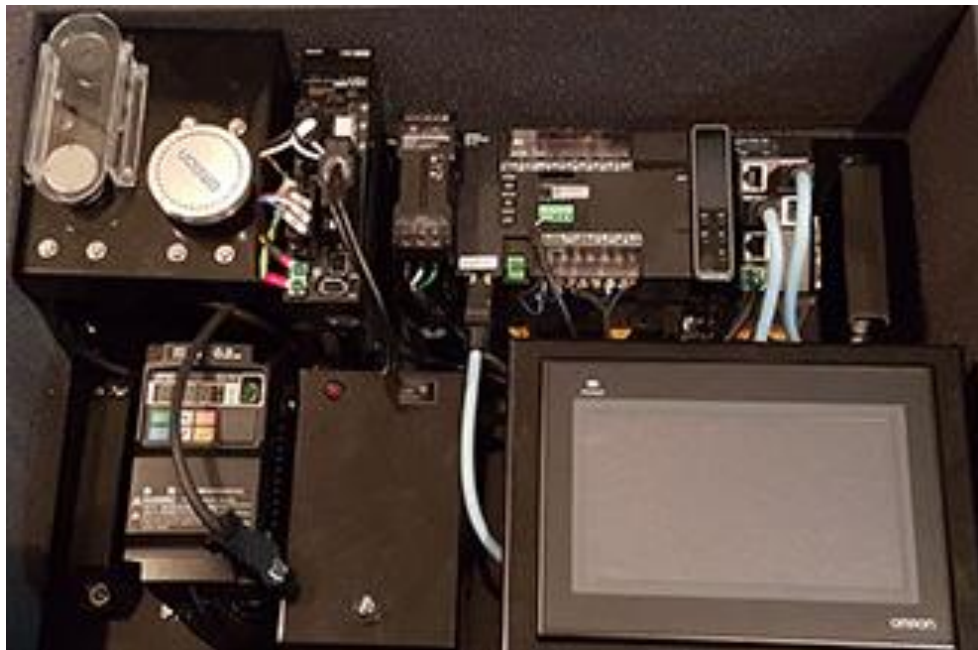
Figura 21. Módulo de entrenamiento Demo PLC y Networking Fuente:(GIEN INDUSTRIES,2015)
