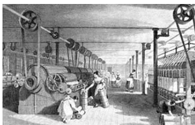
Figura 1. Primeras máquinas accionadas por correas y poleas (1800)
