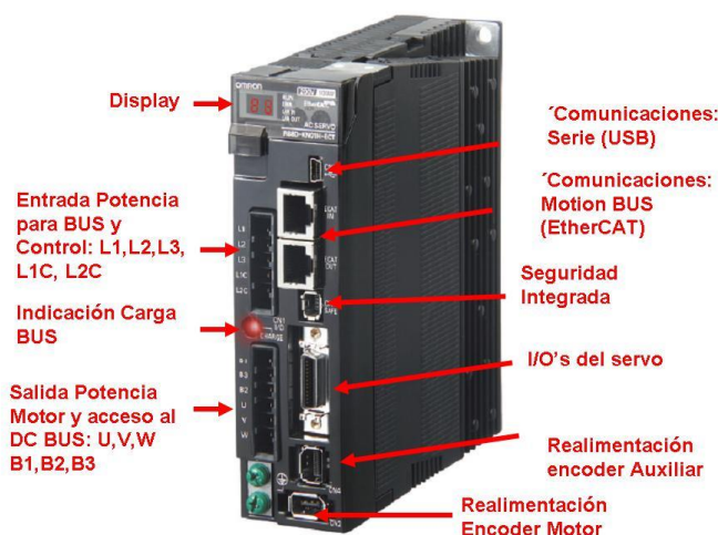
Figura 7. Puertos y elementos básicos del Servo-Drive Fuente:( Motion Control,2016)
