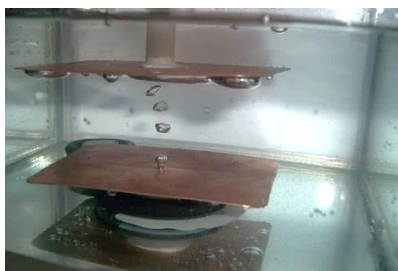
Figura 54. Generación de burbujas sin un campo eléctrico
