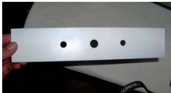
Figura 47. Soporte aislante del conjunto eje-electrodo tipo II
