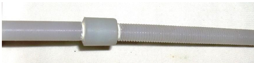
Figura 46. Eje de nylon para generar movimiento
