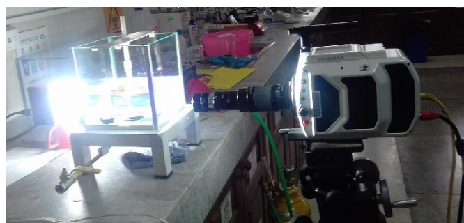
Figura 53. Colocación fija de la cámara de alta resolución
