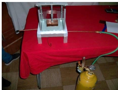
Figura 51. Conexión al recipiente de nitrógeno
