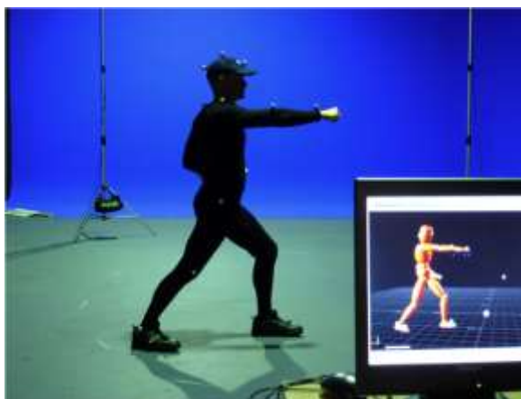
Figura 11. Sistema de captura de movimiento basado en marcadores.
