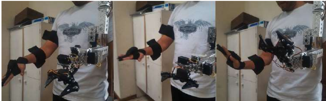
Figura 19. Plataforma didáctica para telerobótica desarrollada por Granda y Quiñónez. Fuente: (Granda & Quiñónez , 2016).
