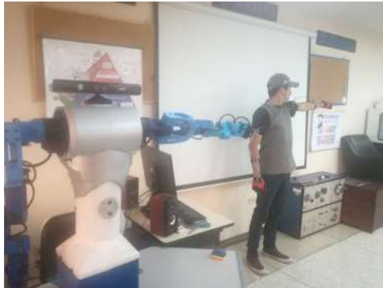
Figura 55. Pose de prueba 2 con sensores inerciales.
