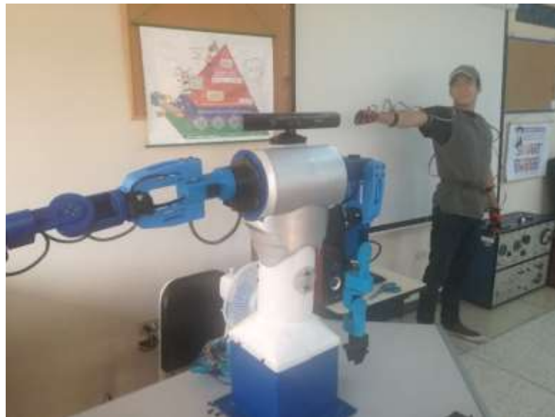
Figura 59. Pose de prueba 4 con sensores inerciales.
