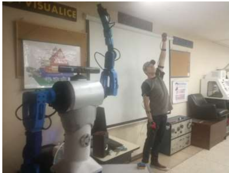
Figura 57. Pose de prueba 3 con sensores inerciales.
