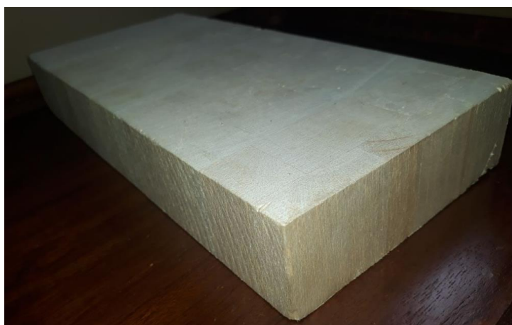
Figura 11 Muestra de núcleo rígido elaborado a base de balsa ( Ochroma pyramidale )
