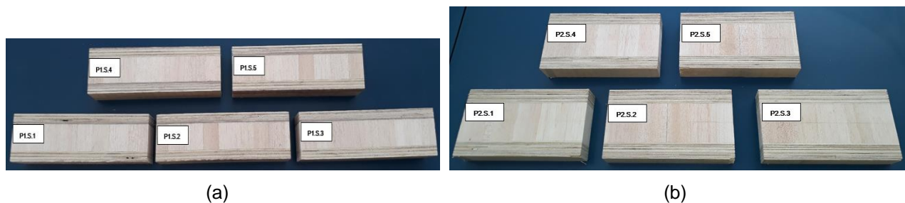
Figura 48 Muestras para ensayo de corte (a) prototipo 1, (b) prototipo 2
