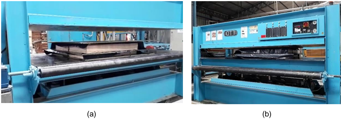
Figura 32 Prensado de tablero estructural tipo sándwich (a) tablero antes de aplicar presión, (b) tablero después de aplicar presión.
