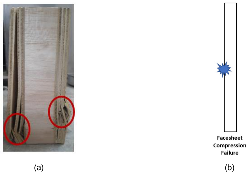
Figura 75 (a) Falla presentada al momento de ensayar el modo mecánico de compresión, (b) falla admisible según norma ASTM C364
