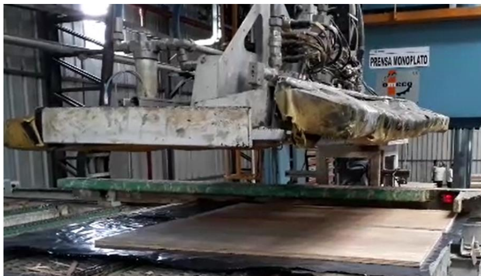
Figura 28 Colocación de poliuretano en panel externo inferior de melina
