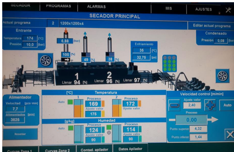
Figura 22 Configuración de equipo de secado
