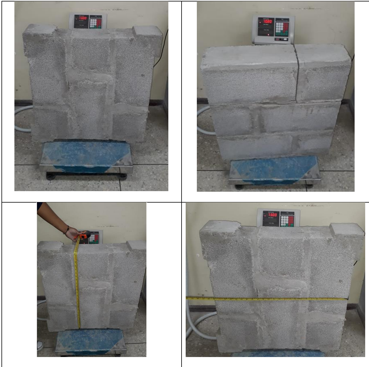
Figura 88 Medición y pesado de cada una de las paredes de bloque
