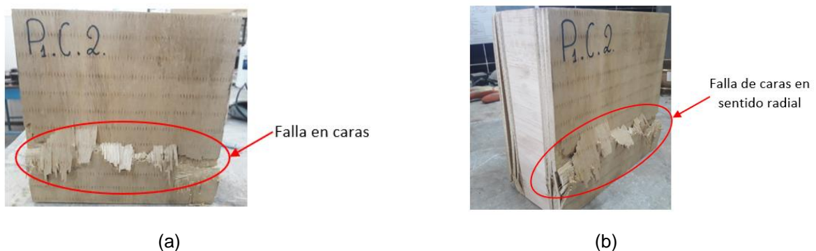
Figura 74 (a) Tipo de falla en el prototipo de tablero estructural tipo sándwich, (b) evolución de falla en sentido radial.
