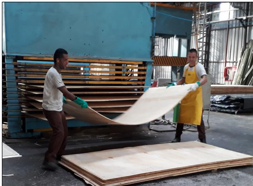
Figura 24 Extracción de CLT de melina y apilado
