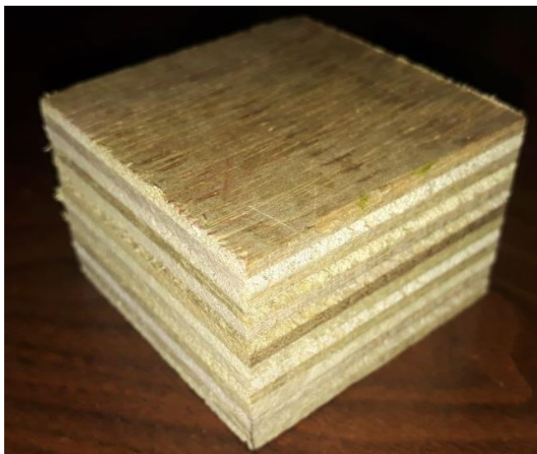
Figura 5 Muestra de CLT elaborado a base de Gmelina arbórea y tomado de uno de los prototipos usados en esta investigación
