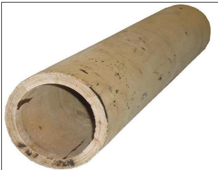
Figura 7 Poste de transmisión eléctrica elaborado en base a coconut veneers based composites.
