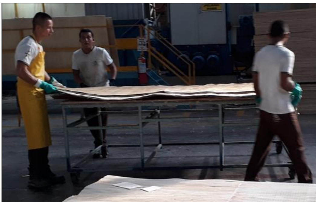
Figura 23 Distribución de chapas de melina para conformar un CLT
