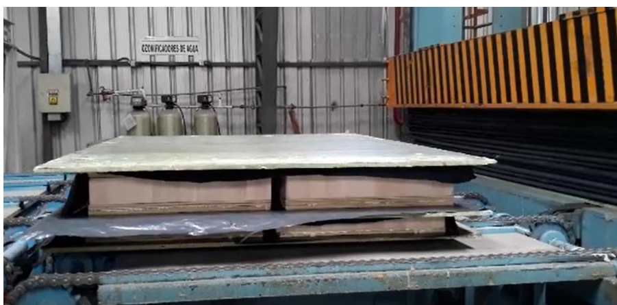
Figura 31 Transporte de prototipos de tableros tipo sándwich a la prensa monoplato
