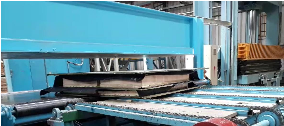
Figura 33 Etapa final del proceso de elaboración del prototipo de tablero estructural tipo sándwich
