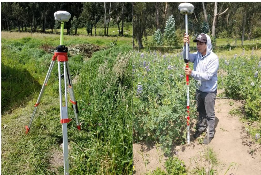
**Figura 23. (Izq.)** Estación base y **(Der.)** móvil para la georreferenciación de las plantas.
