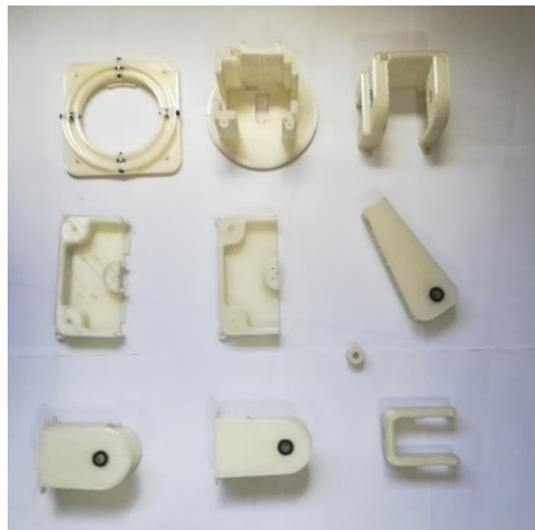
Figura 29. Partes impresas en 3D
