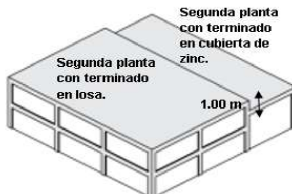
Figura 73. Esquema de niveles divididos en nivel de techo en la vivienda de la Sra. Marlene Campos Pereira.
