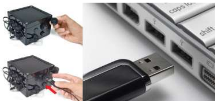
Figura 10 Instalación de cable USB para transferencia de datos
