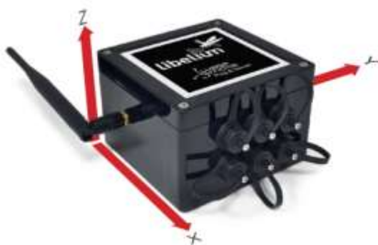
Figura 9 Dirección de Ejes en Wasmote Plug&Sense
