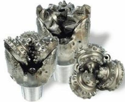
Todas las brocas cuentan con uno o varios pasajes de fluido, que orientados a través de orificios (jets) permiten la circulación del fluido de perforación que lubrica la broca y controla la temperatura de fondo.
