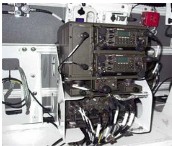
Figura 22 Sistema integral de radio táctica para vehículo blindado
