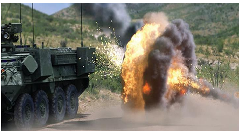
Figura 21 Sistema de protección activa (hard kill)
