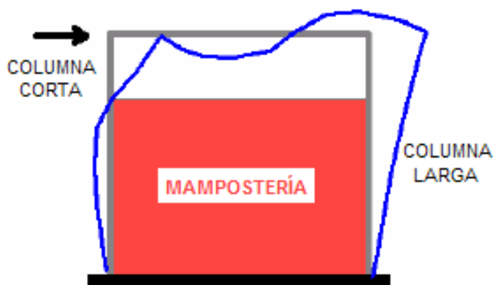
Figura 4.16 Comportamiento de las columnas de un pórtico simple
