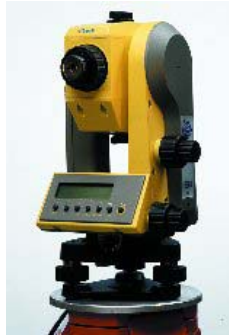
Figura 2.5: (Estación total TRIMBLE 3305DR de la marca Zeiss)
