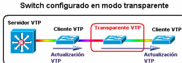
**Figura 2.43 Switch en Modo Transparente con Versión 2 de VTP**
