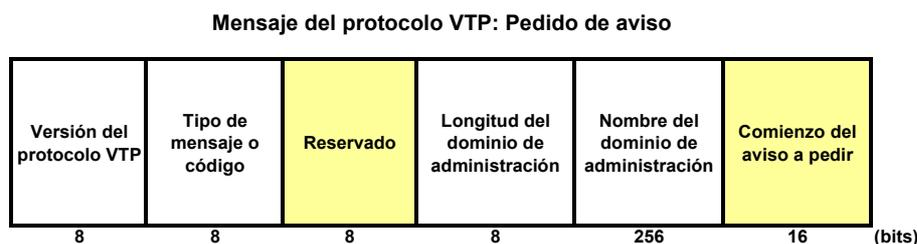
**Figura 2.48 Mensaje del Protocolo VTP: Pedido de Aviso**
