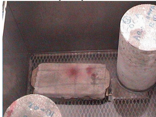
Foto N° 15: Molde de Morteros en tanque de Curado a 22°C por espacio de media hora
