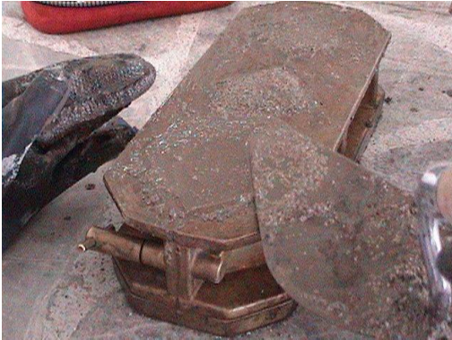
Foto N° 12: Enrasado de mortero en Cubos
