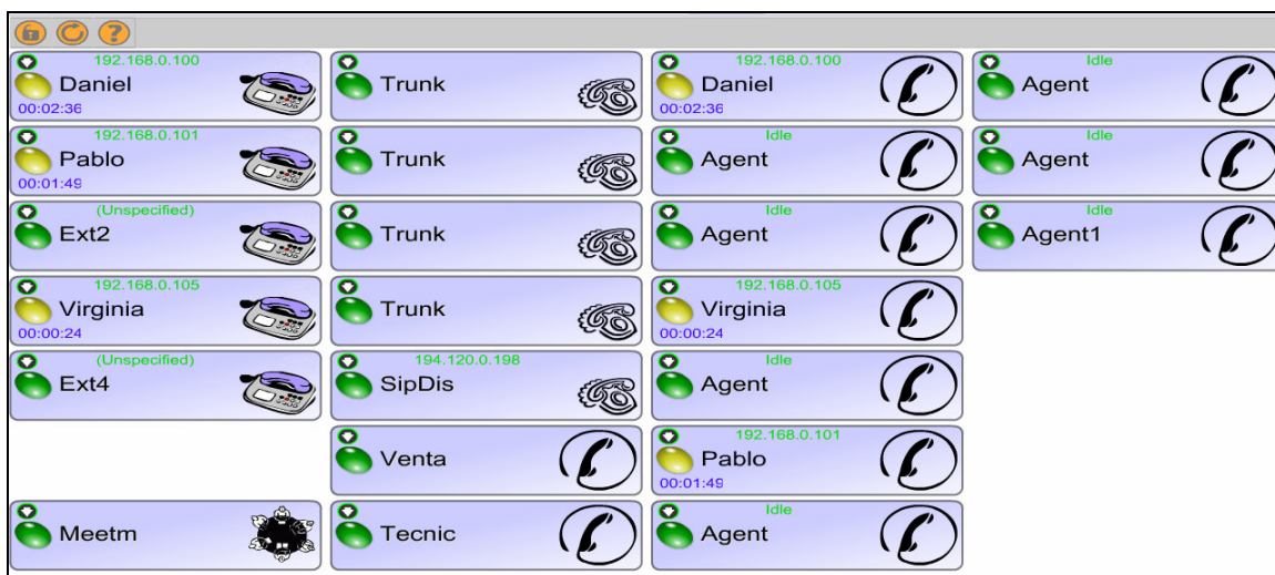
Figura 4. 2 Panel de Operador con agentes registrados
