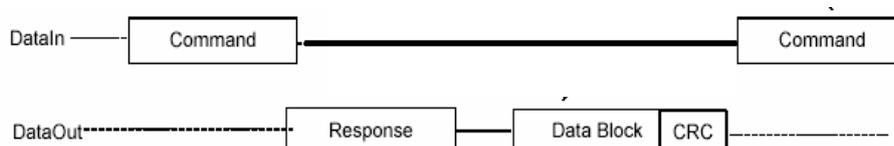
**Figura 3.2 Transferencia de datos del protocolo SPI**
