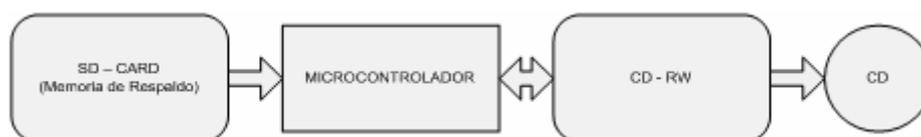
**Figura 2.7 Diagrama de Bloques (Sistema de Grabado CD-RW)**
