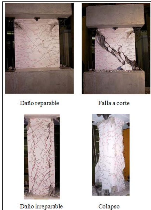
Figura 2.12. Niveles de daño, propuestos por Ghobarah et al. (1997).
