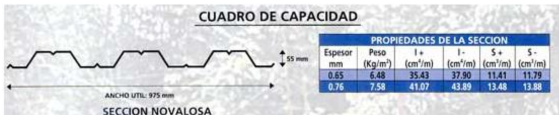
Figura 7.1: Geometría del Deck Metálico
