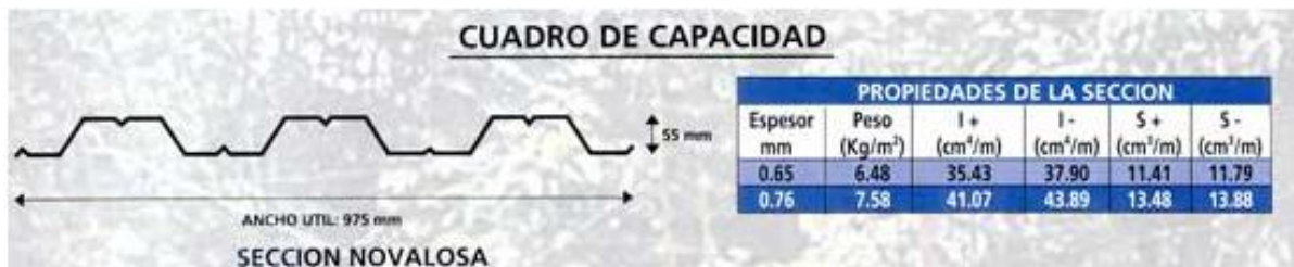
Figura 6.1: Geometría del Deck Metálico
