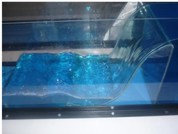
**Fotografía 5.6** Funcionamiento del dissipador tipo esquí sumergido.
