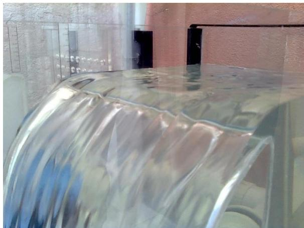
**Fotografía 4.12** Funcionamiento del vertedor sin placa perforada.
