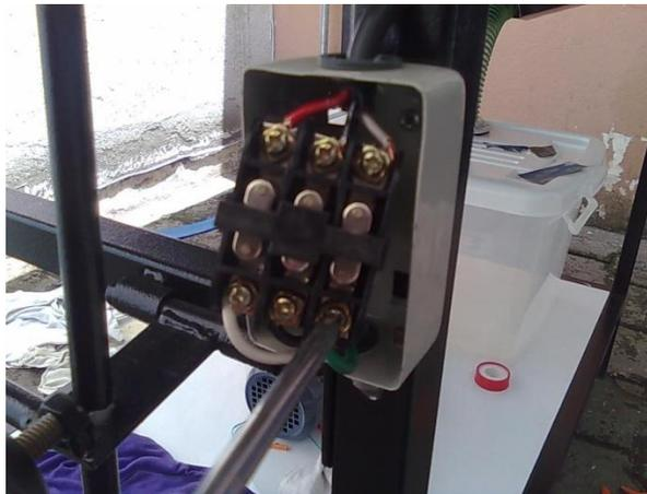
**Fotografía 4.6** Conexión de la botonera a la bomba.
