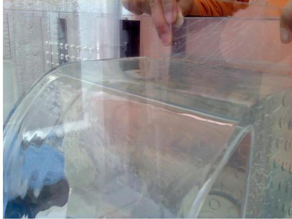
**Fotografía 4.13** Funcionamiento del vertedor con placa perforada.
