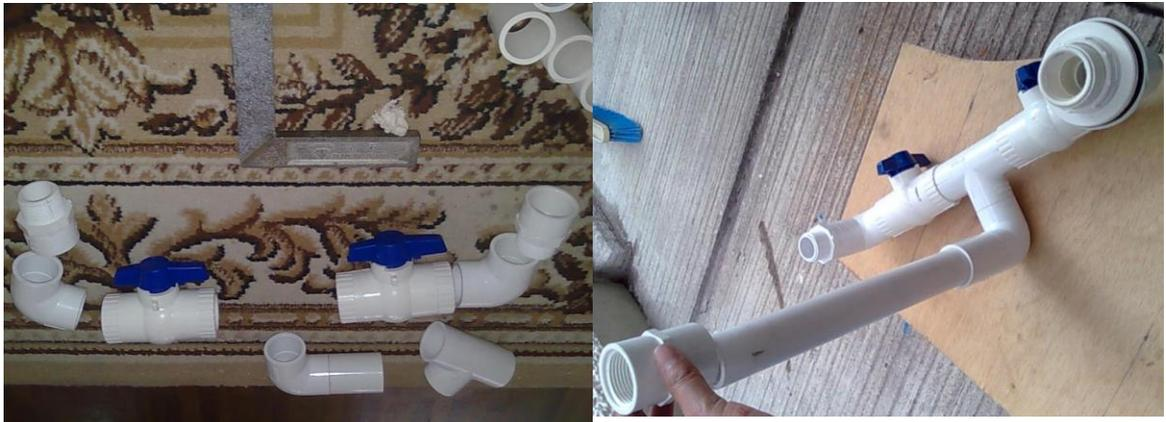
Fotografía 4.5 Unión de la tubería.
