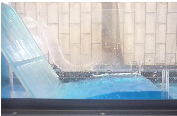
**Fotografía 5.3** Resalto hidráulico normal.
