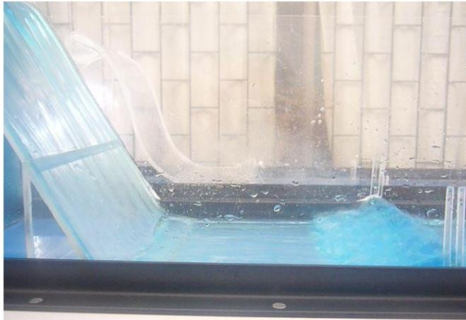
**Fotografía 5.2** Resalto hidráulico desplazado.
