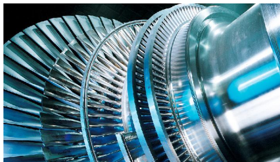
Figura 2.6 Turbina de vapor
