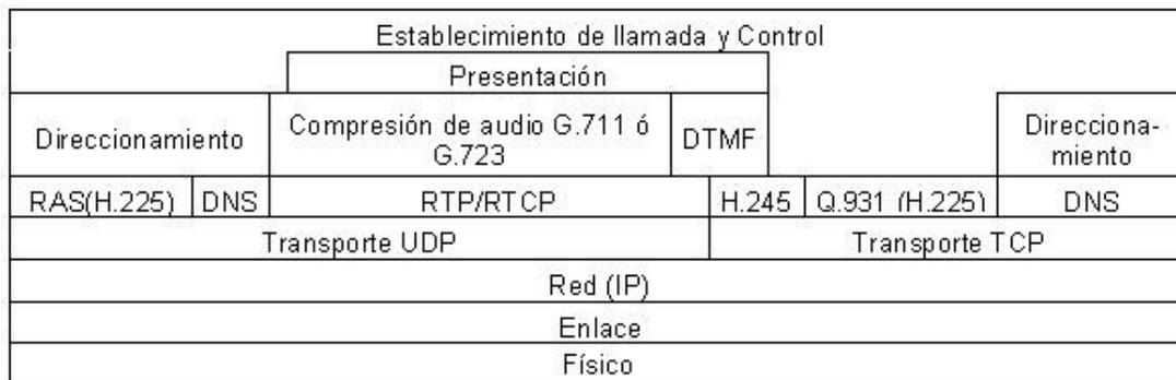
**Figura. 1.2. Pila de protocolos en VoIP**
