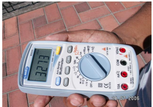
Fotografía 3. 8 Medidor de Luminosidad
