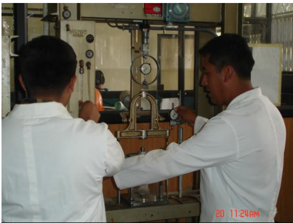
Fotografía 3. 1 Ensayo triaxial de las muestras.
