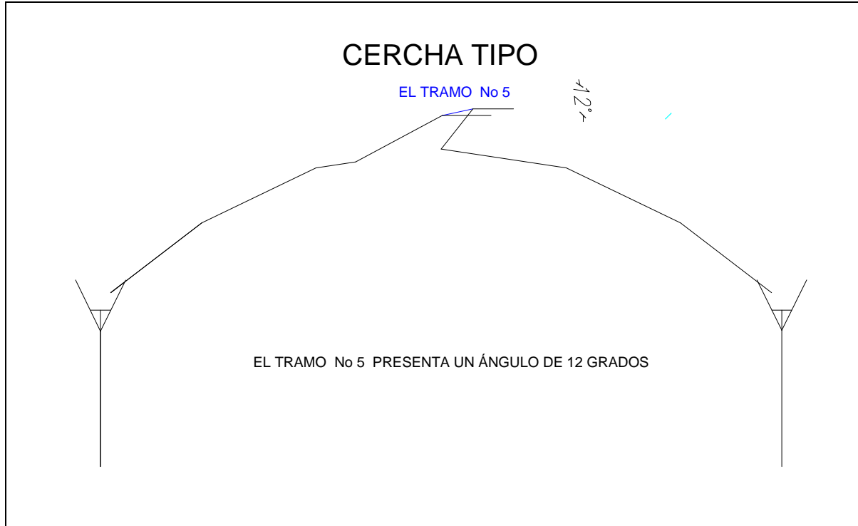
Figura 4. 8 Tramo 5 de La Cercha del Invernadero.
