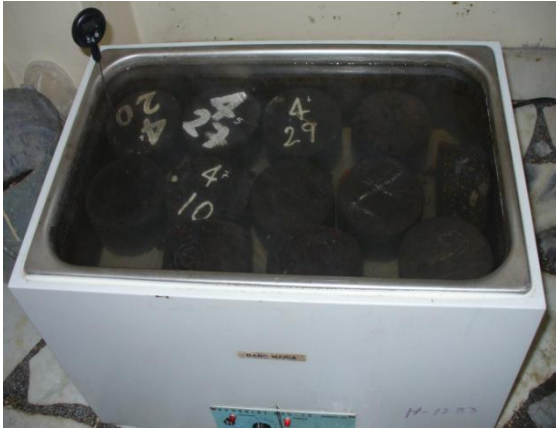
Fig. IV Briquetas en baño maría y ensayo marshall
