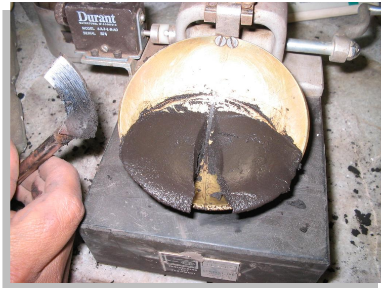
Foto No.4.9: Aparato de casagrande usado para determinar el límite líquido.
