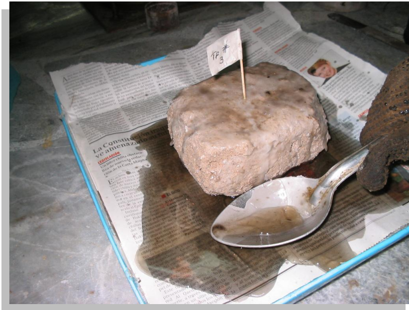
Foto No.4.7: Colocación de parafina en una muestra.
