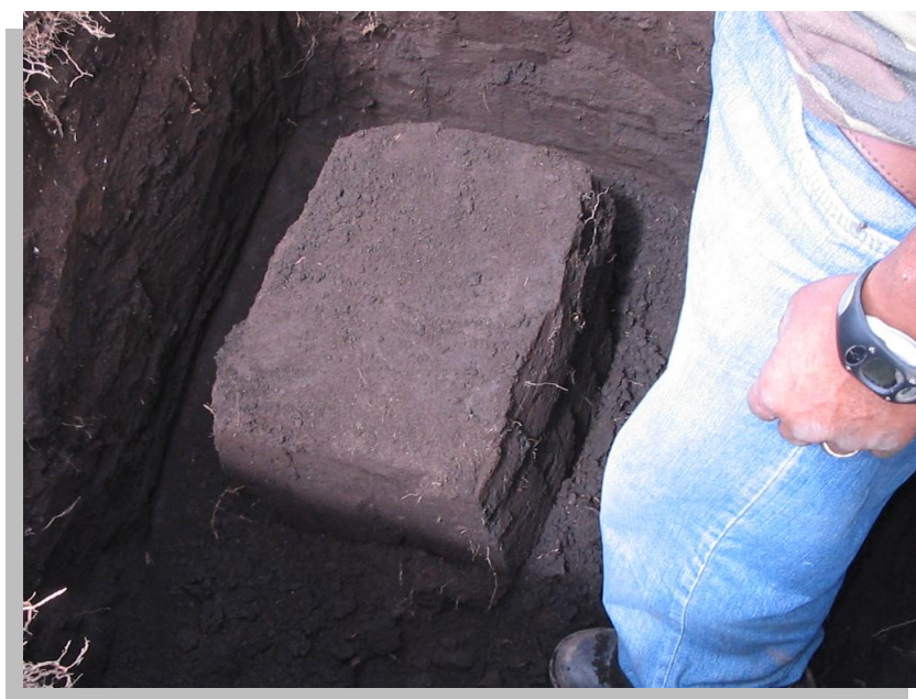
Foto No.4.2: Muestra inalterada a 0.50 m en la abscisa 4+500.
