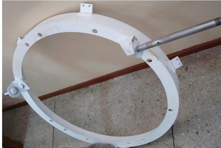
**Figura 5.2.** Soporte circular de aluminio y eje acero
