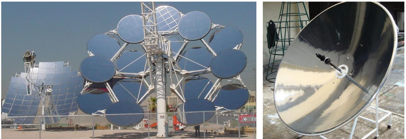
**Figura 3.10.** Distintas configuraciones de colectores de disco
