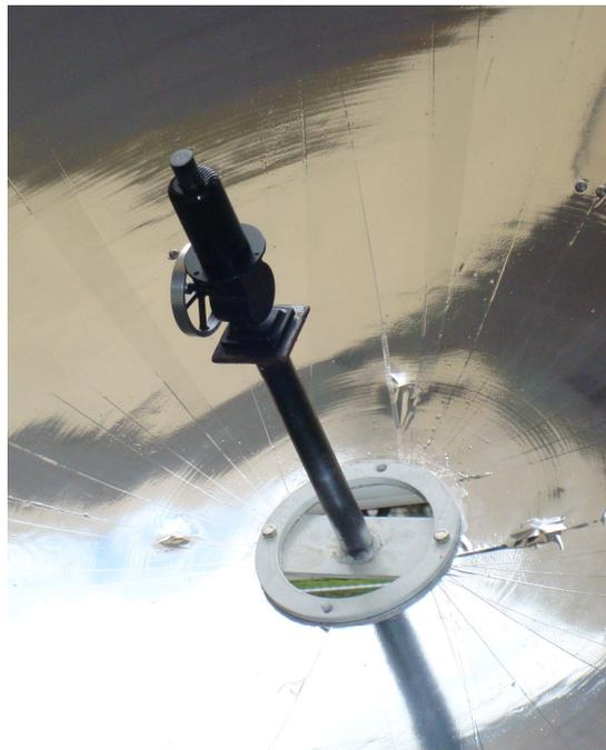
**Figura 5.5.** Soporte de motor acoplado a la antena
