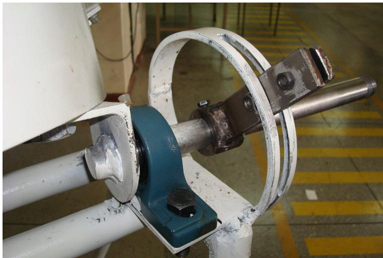
**Figura 5.3.** Sistema de freno para posicionamiento correcto
