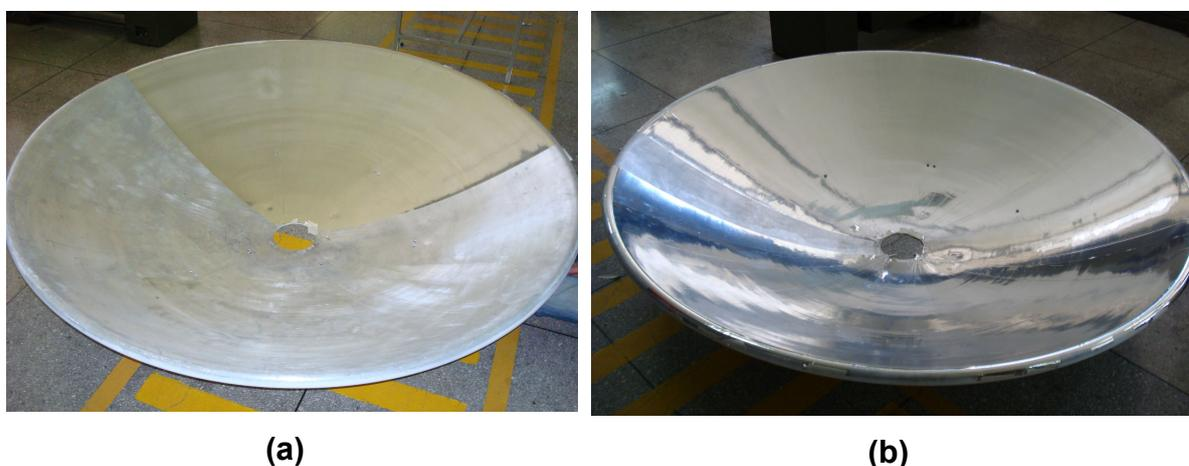
**Figura 5.4.** Colocación de película sobre la antena: (a) Colocación inicial
