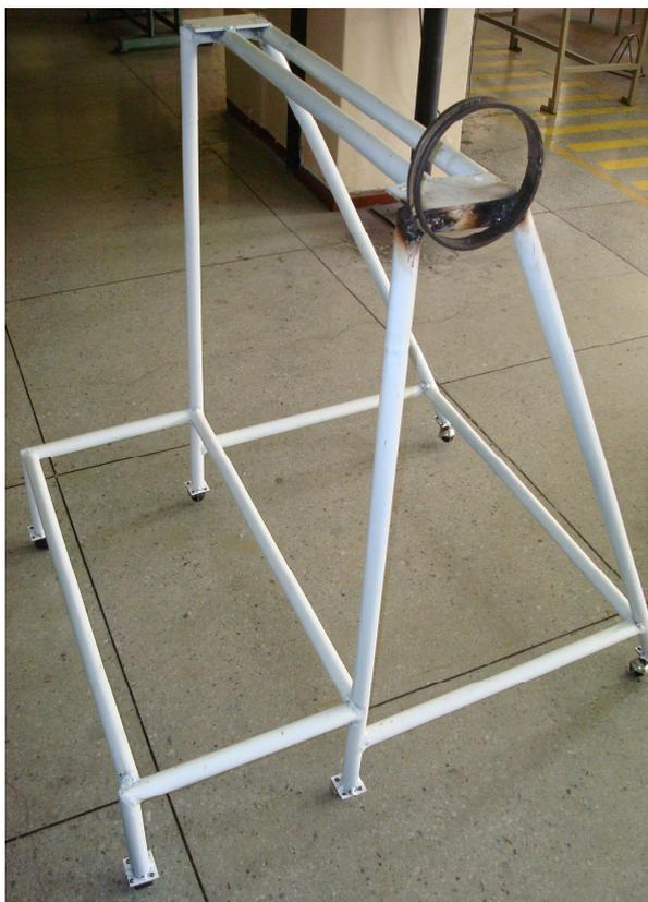
**Figura 5.1.** Soporte de acero del concentrador
