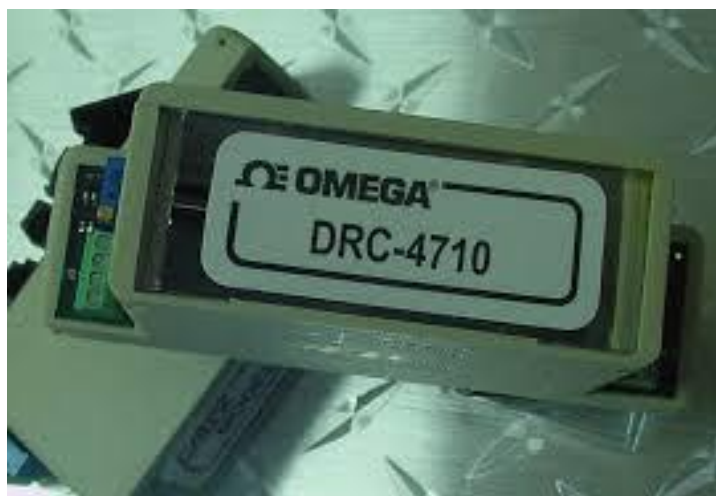
Figura 37. Transmisor de Peso Fuente: (Omega, 2018)
