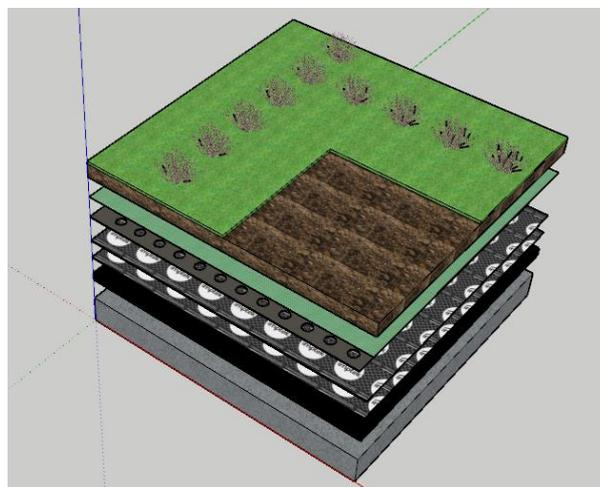
**Figura 72.** Nivel 3- sistemas de impermeabilización jardinerías.
