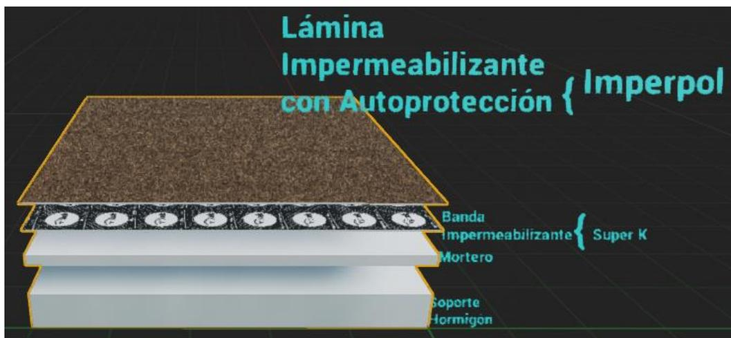
**Figura 21.** Sistema de impermeabilización – Cubierta plana.
