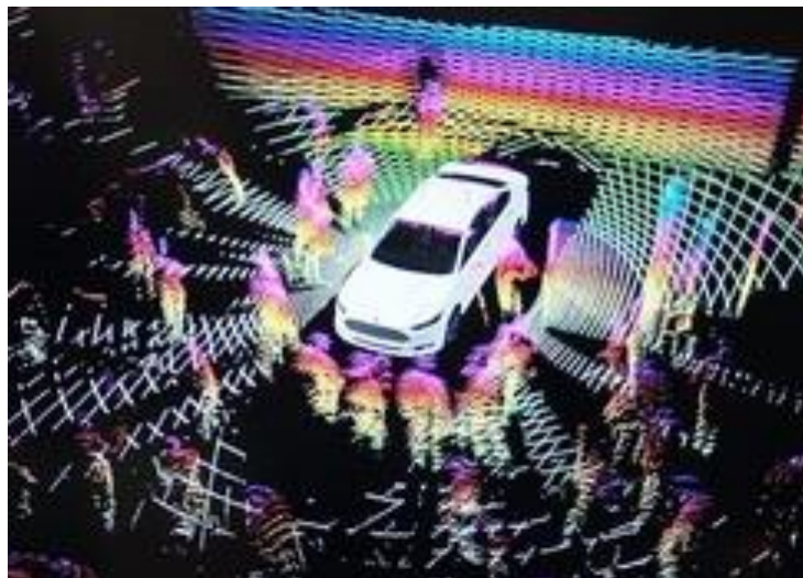
Figura 31 Mapeo con un sensor LIDAR
