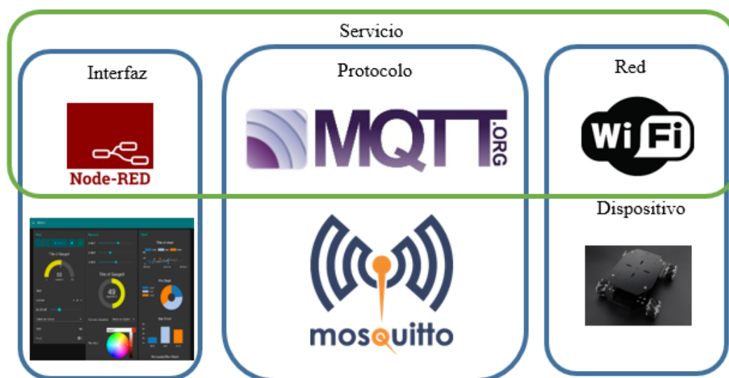
Figura 61 Conexión de elementos mediante MQTT
