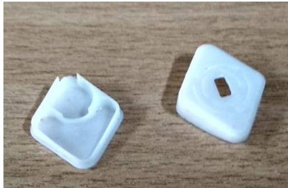
*Figura 51.* Carcasa del dispositivo EyeBorg impresa en SLA
