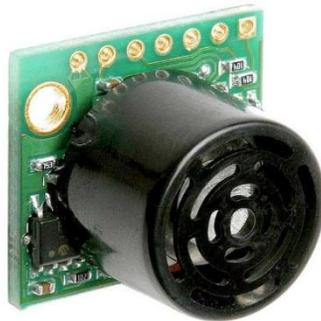
**Figura 27.** Sensor ultrasónico Maxbotix MB1000
