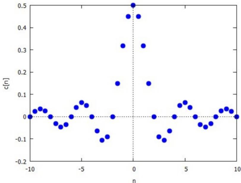
Figure: Gráfica de las componentes espectrales del tren de pulsos para un periodo  $T = 2$
