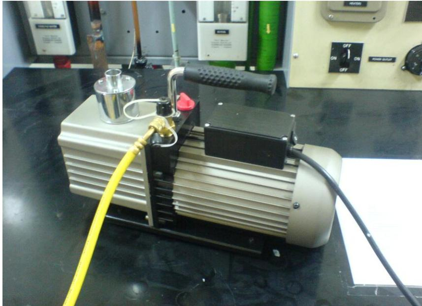
**Fig. 4.2 Vaciado del Equipo.**
