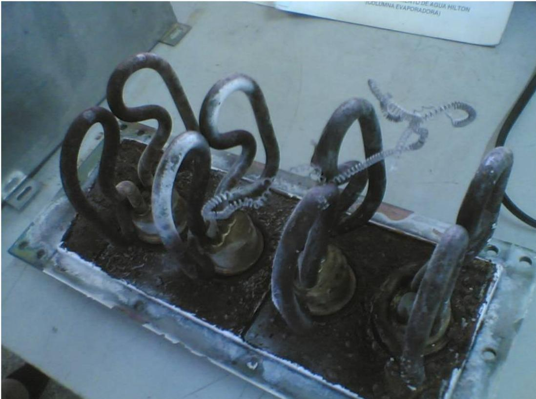
**Figura 2.14 Estado de los conductos y resistencias**
