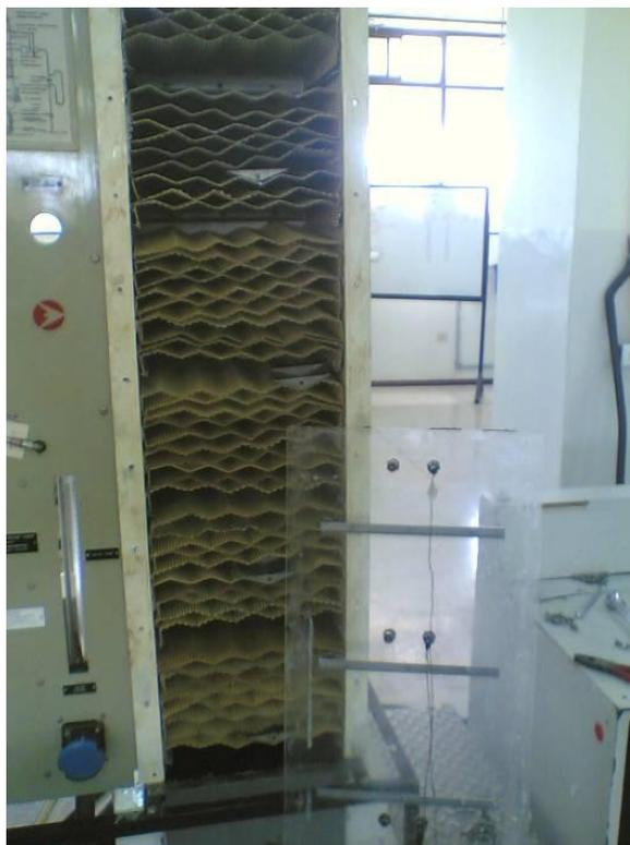
**Figura 2.6 Láminas metálicas y Acrílico Frontal de la Torre**
