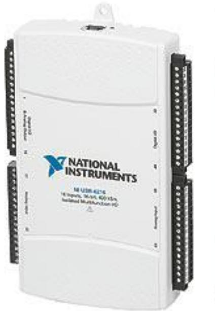
**Figura 4.8 Tarjeta de Adquisición de Datos USB-6218**
