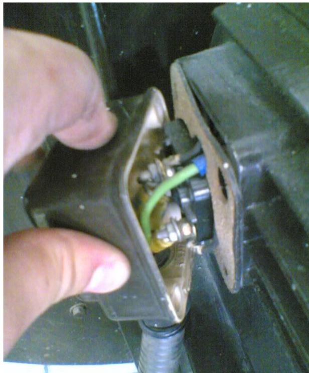
**Figura 2.8** Detalle de la conexión trifásica del motor
