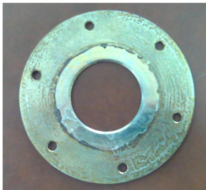
**Figura 5.24 Placa Orificio de la torre**
