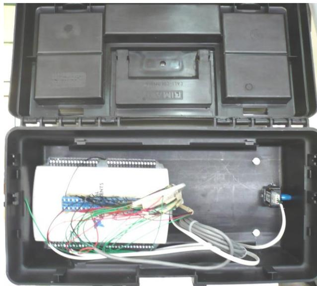
**Figura 4.28 Conexiones al DAQ**
