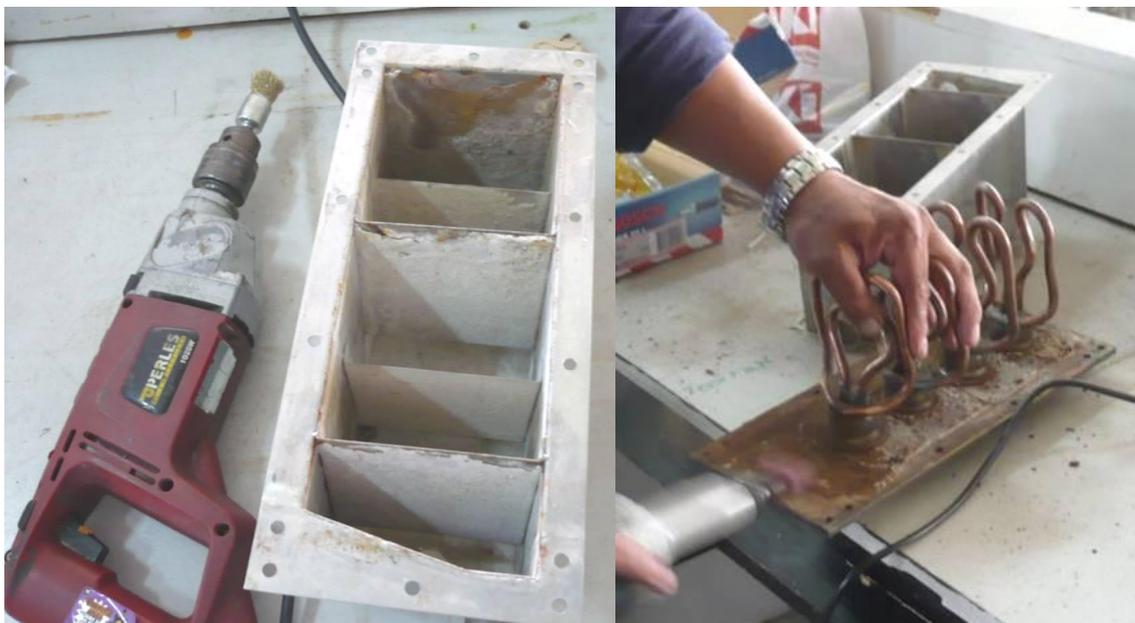
**Figura 4.15 Limpieza de la Caja y de las resistencias**
