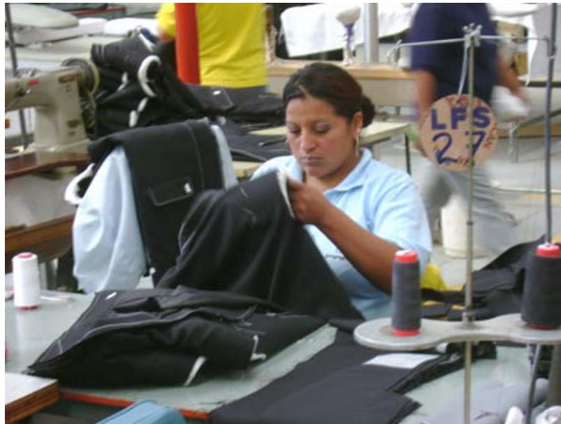
Foto No. 1.9 Colocación de hombros
