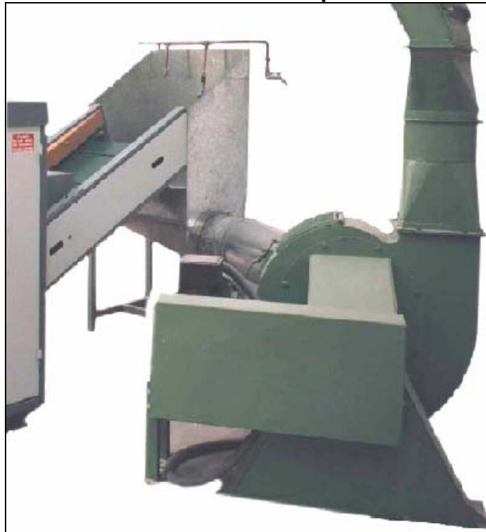
Foto No. 5.4 Ventilador de transporte
