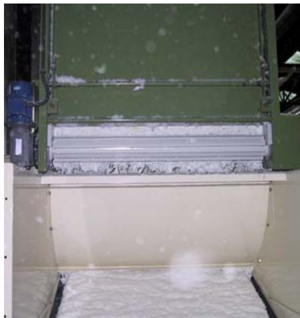
Foto No. 5.7 Silo alimentador dosificador
