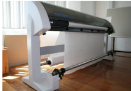
Fotografía N.- 11 Ploter Fotografiado por: Iván Oña Ñ.
