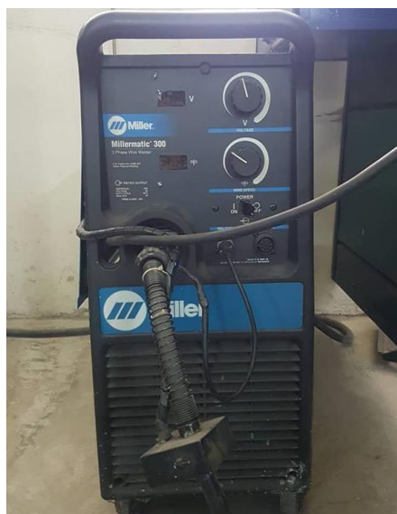
Figura 22. Soldadora MillerMatic 300, usada para proceso de soldadura MIG/MAG perteneciente a la Universidad de las Fuerzas Armadas – ESPE
