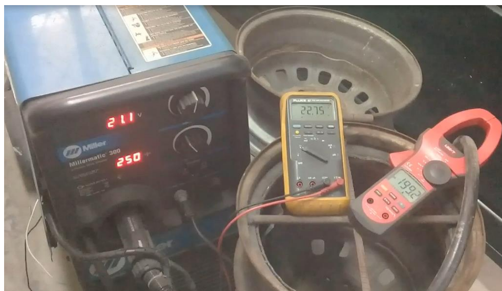
Figura 23. Calibración de la soldadora MillerMatic 300 a través de la Verificación de los parámetros de salida mediante el uso de una pinza amperimétrica UNI-T UT208 y un multímetro FLUKE 87V
