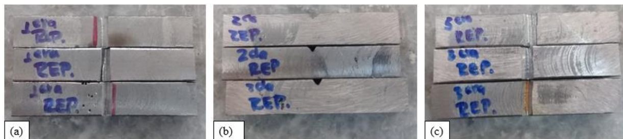
Figura 42. Probetas de impacto (a) Probetas de impacto del ensamble de la primera reparación. (b) Probetas de impacto del ensamble de la segunda reparación. (c) Probetas de impacto del ensamble de la tercera reparación
