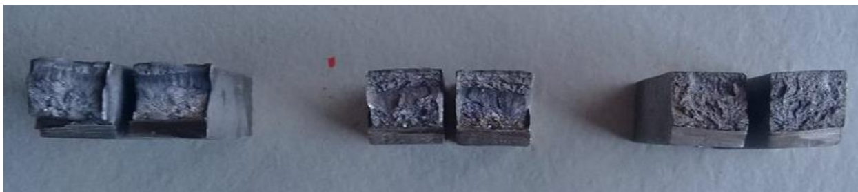
Figura 75. Falla frágil presente en las probetas de impacto de las distintas reparaciones realizadas
