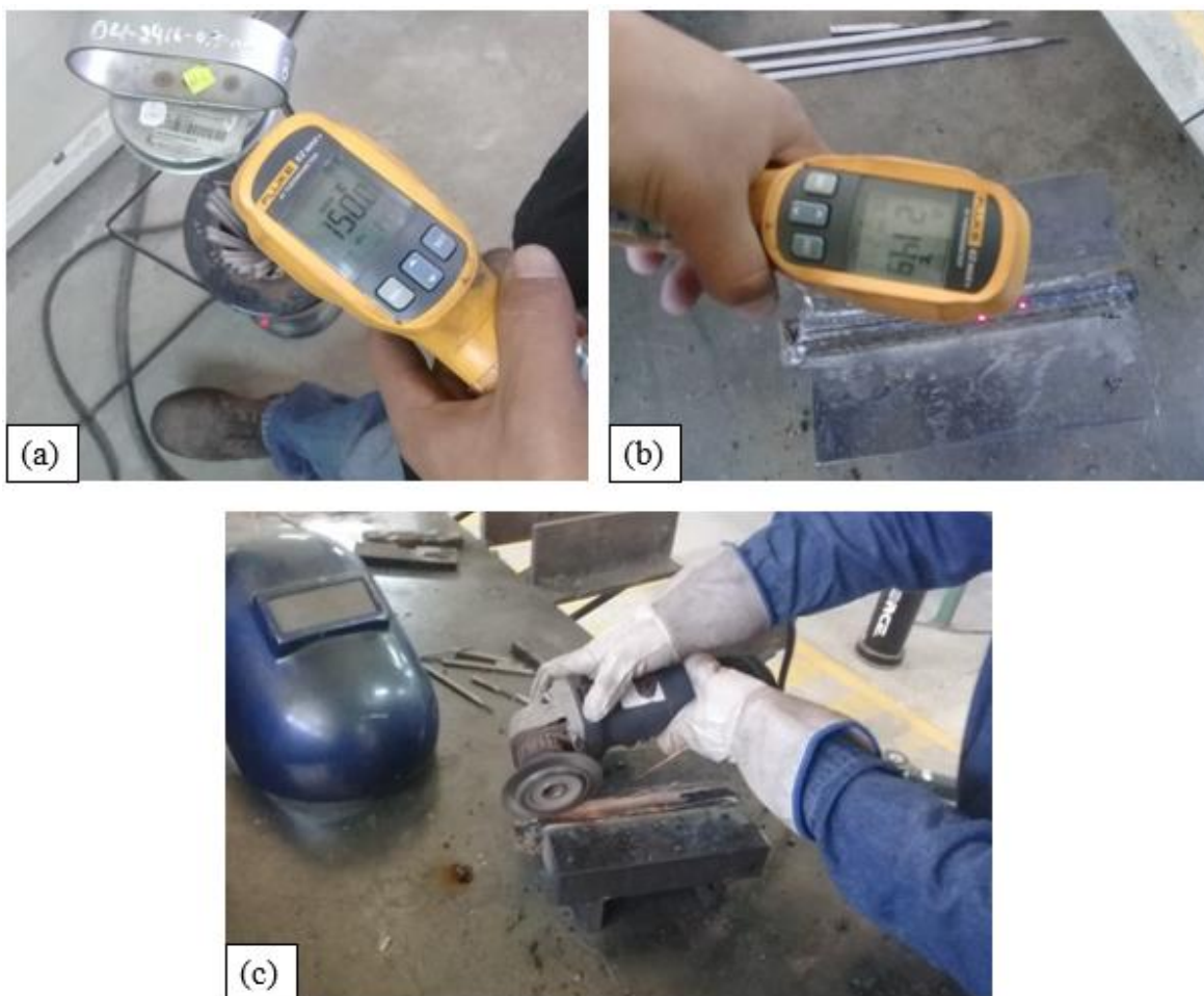
Figura 35. Control y soldeo de los ensambles de reparación. (a) Resecado de los electrodos E-7018 (b) Control de la temperatura entre pases. (c) Limpieza de la ranura de reparación, previo a la realización de la reparación mediante proceso SMAW
