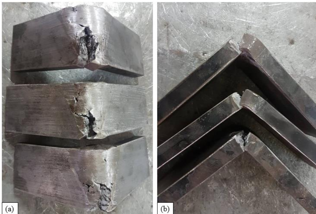
Figura 68. Probetas dobladas del ensamble con una reparación
