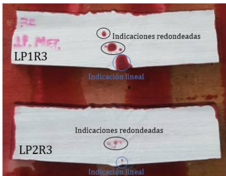
Figura 51. Ensayo de líquidos penetrantes aplicado a las probetas LP1R3 y LP2R3 del ensamble con tres reparaciones
