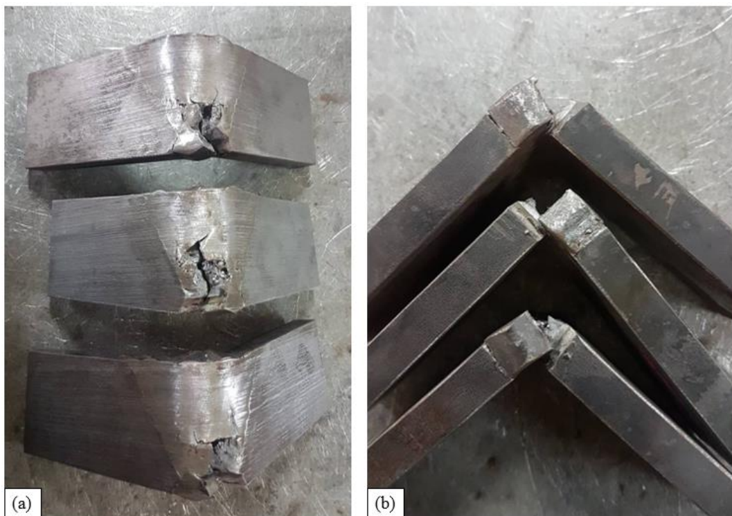
Figura 70. Probetas dobladas del ensamble con dos reparaciones
