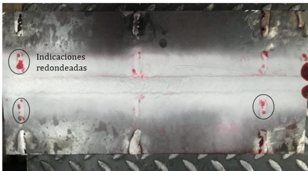
Figura 47. Ensayo de líquidos penetrantes aplicado a la superficie del ensamble de producción
