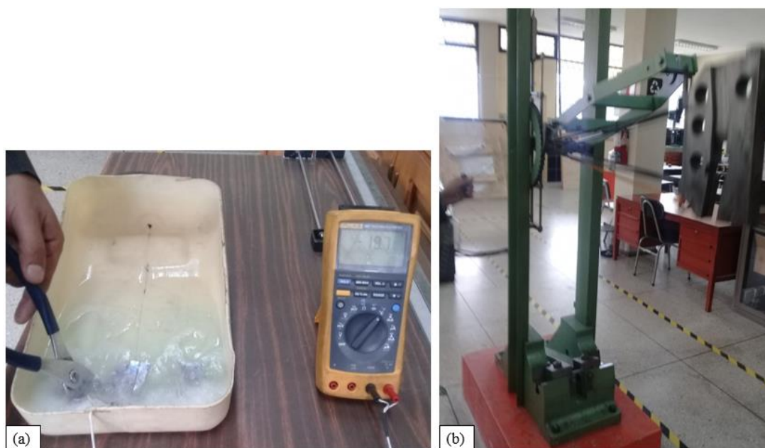
Figura 43. Ensayo de impacto (a) Reducción de la temperatura, esta ira disminuyendo progresivamente hasta un valor de -31^{\circ}\text{C} . (b) Aplicación del ensayo de impacto a una probeta
