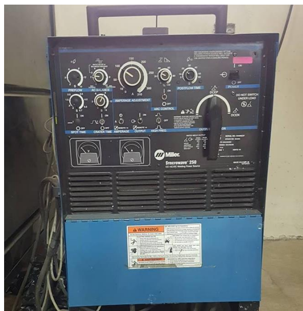
Figura 24. Soldadora MillerMatic Syncrowave 250, usada para proceso de soldadura GTAW/SMAW perteneciente a la Universidad de las Fuerzas Armadas – ESPE
