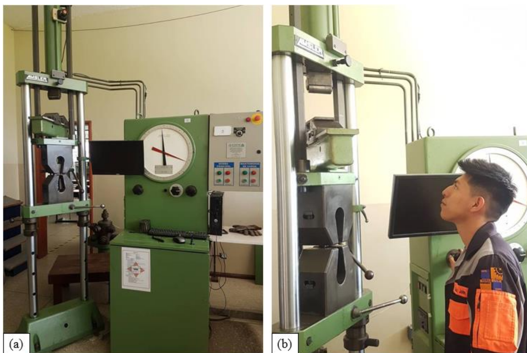
Figura 38. Pruebas de Flexión. (a) Maquina de Ensayos Universales AMSLER (Universidad de las fuerzas Armadas - ESPE). (b) Ensayo de doblado lateral junto a sus componentes principales (Rodillos, Soportes, Probeta a ensayar)
