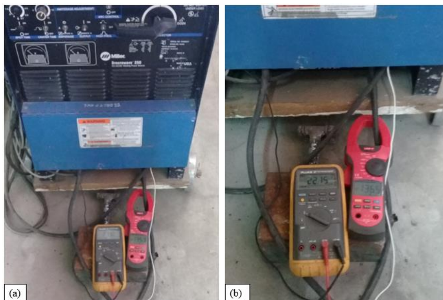
Figura 25. Calibración de la soldadora MillerMatic Syncrowave 250. (a) Verificación de los parámetros de salida mediante el uso de una pinza amperimétrica UNI-T UT208 y un multímetro Fluke 87V (b) Valores de intensidad de corriente y voltaje, obtenidos a la salida de la soldadora
