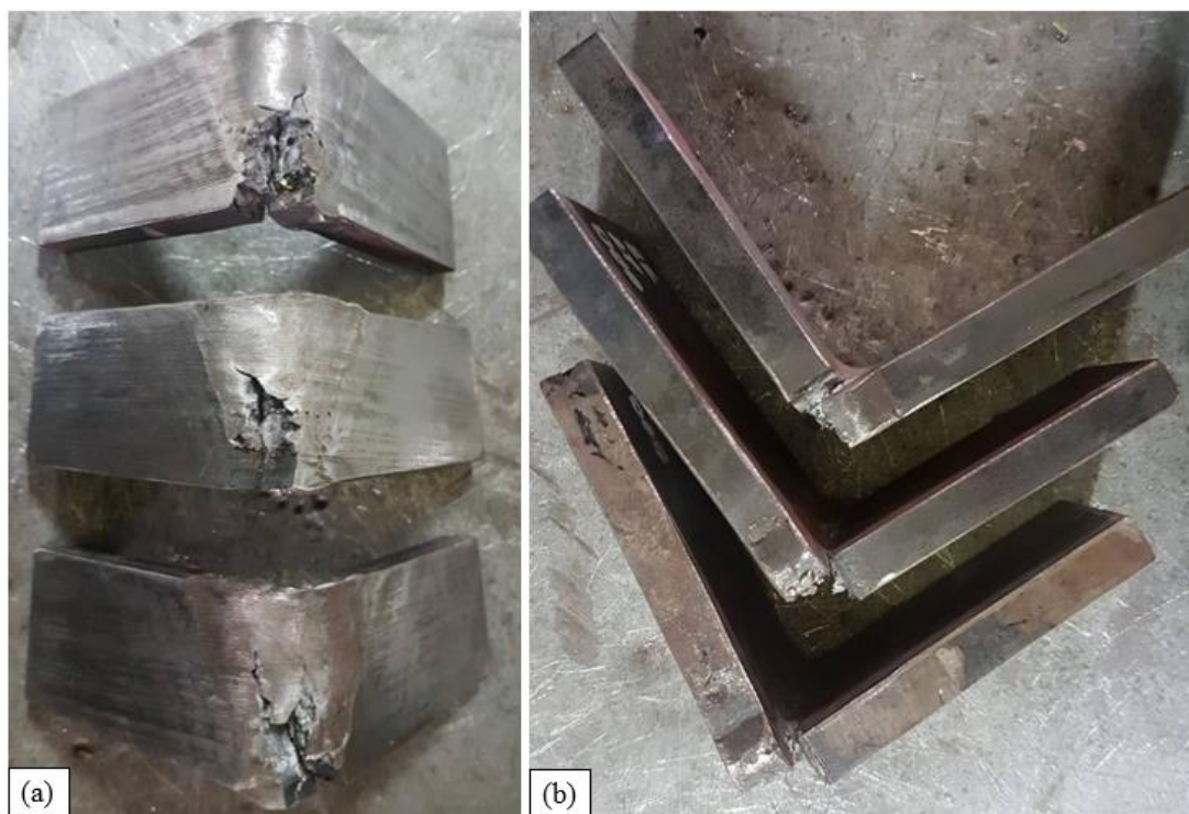
Figura 72. Probetas dobladas del ensamble con tres reparaciones
