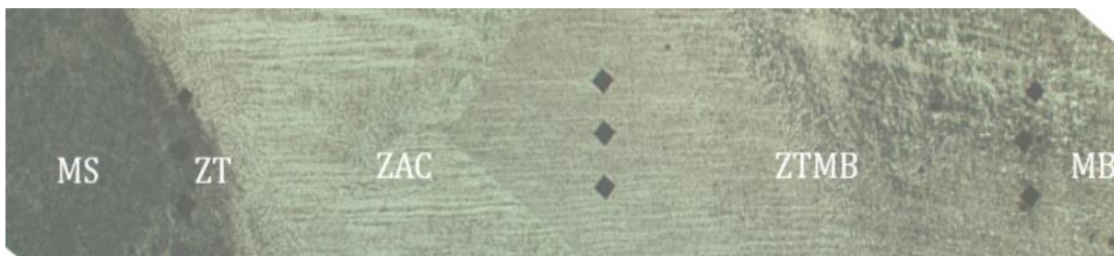
Figura 63. Zonas de las probetas donde se realizaron las indentaciones, para la determinación del perfil transversal de microdureza HV
