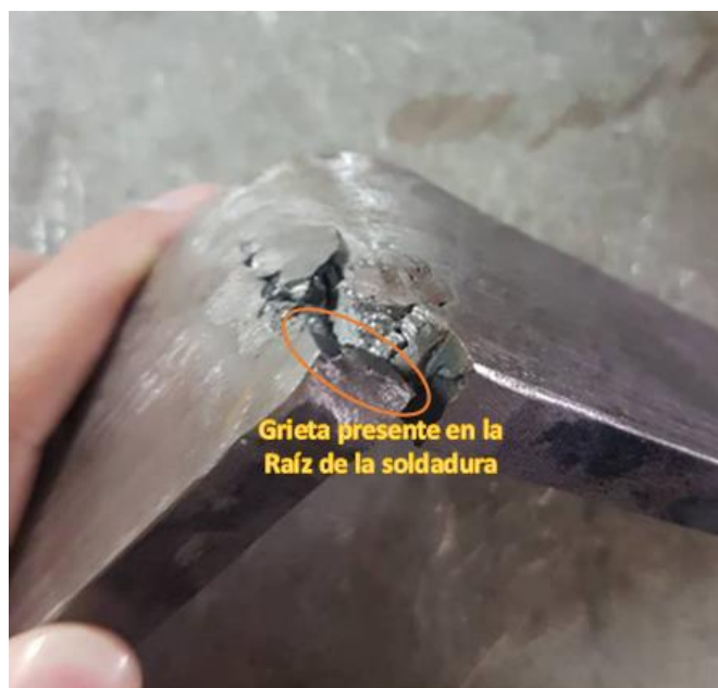
Figura 73. Iniciación de la falla de la probeta de doblado del ensamble con tres reparaciones, debido a la presencia de una grieta en la raíz
