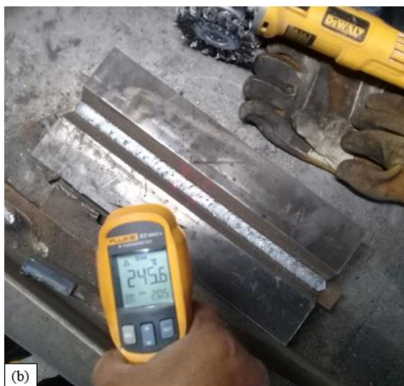
Figura 33. Ensamble de Producción. (a) Pre calentamiento de los cupones de producción y de reparación. (b) Control de la temperatura entre pases del ensamble de producción mediante el termómetro laser Fluke 62 Max
