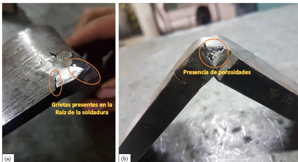
Figura 71. Defectos en las probetas de doblado del ensamble con dos reparaciones. (a) Iniciación de la falla de la probeta de doblado del ensamble con dos reparaciones, debido a la presencia de grietas en la raíz. (b) Porosidades presentes en la parte baja de la probeta de doblado del ensamble de dos reparaciones
