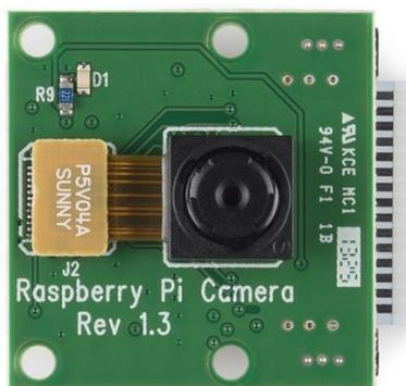
**Figura 5.** Sensor de imagen CMOS Sony IMX219PQ
