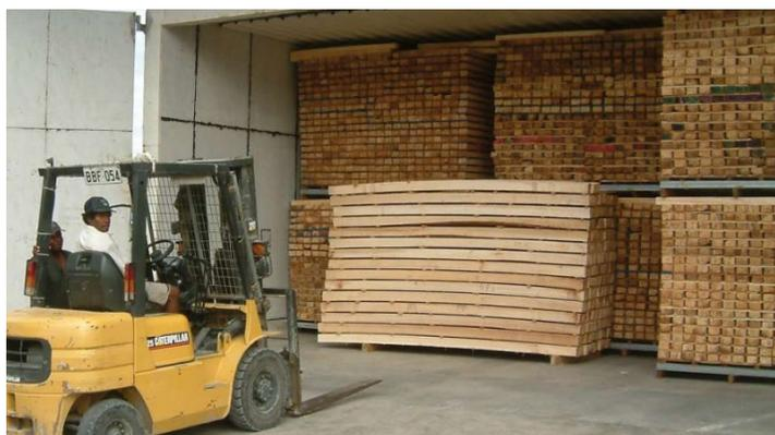
**Figura 32** Listones de balsa en horno de secado
