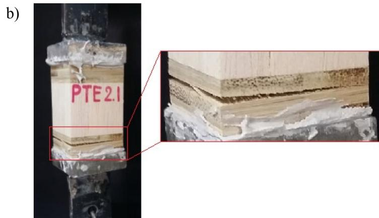
**Figura 55** Modo de falla en muestras representativas de tracción a) prototipo 1 y b) prototipo 2
