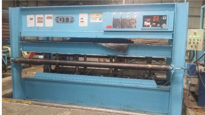
**Figura 36** Proceso de ensamblaje de tableros a) encolado de poliuretano en paneles y b) prensado de tableros
