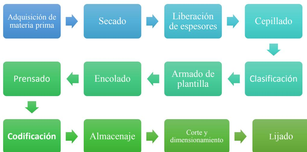
**Figura 31** Diagrama de flujo del proceso de industrialización de la balsa para convertirlo en panel end-grain
