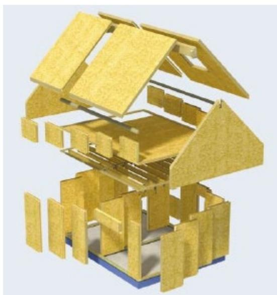
**Figura 89** Sistema constructivo de paneles estructurales aislados
