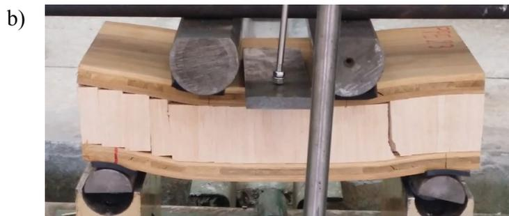
**Figura 59** Modo de falla en muestras representativas de flexión a) prototipo 1 y b) prototipo 2
