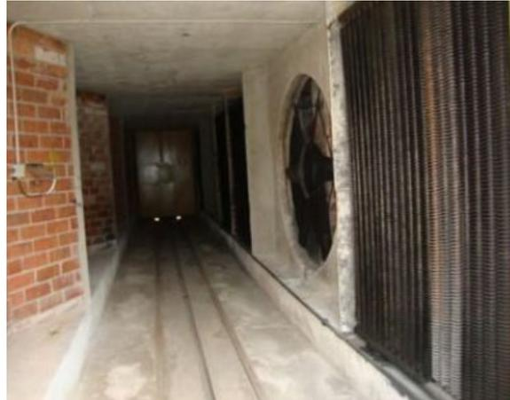
**Figura 25** Horno de secado de latillas
