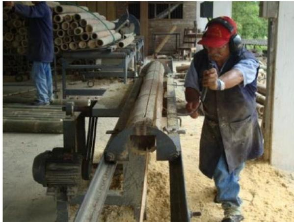
*Figura 19* Latillado de bambú rollizo
