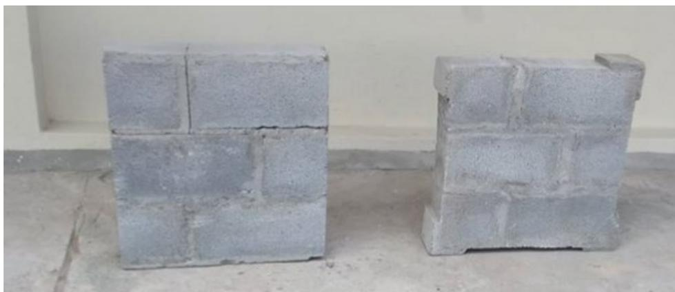
**Figura 85** Paredes de bloque elaboradas
