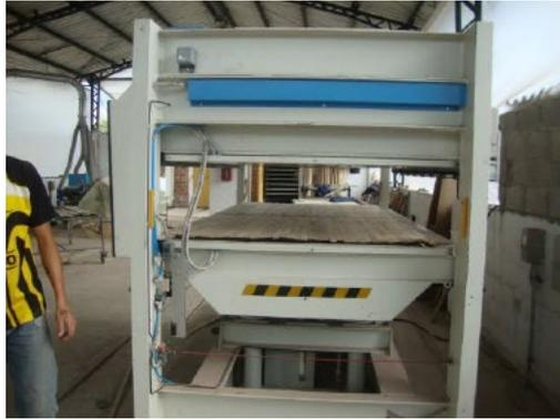
**Figura 29** Prensado de laminados
