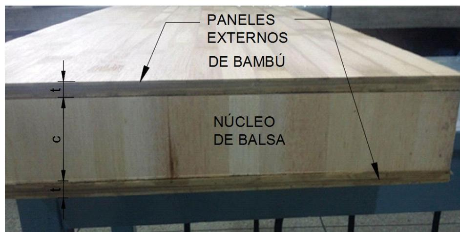
**Figura 5** Composición de la estructura tipo sándwich, representada en uno de los prototipos de tablero elaborados para el presente estudio
