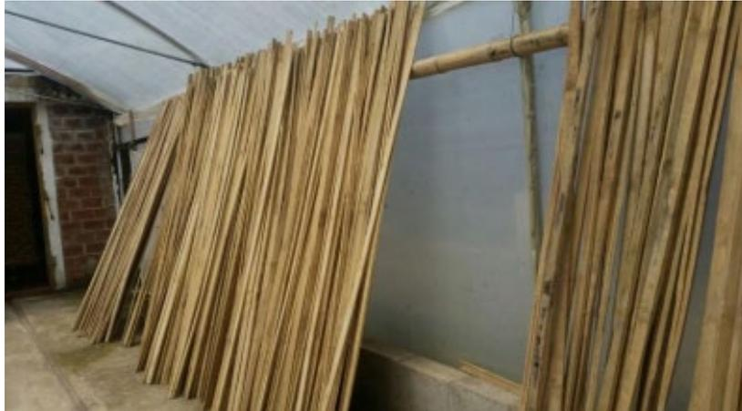
**Figura 23** Presecado de latillas
