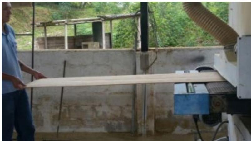
**Figura 30** Lijado de laminados de bambú
