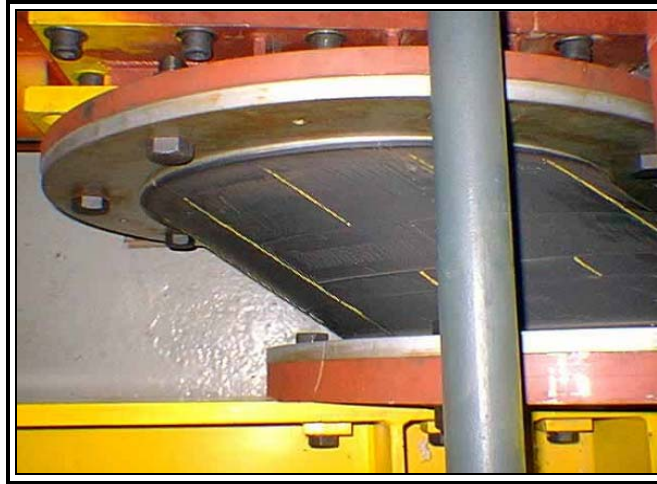
Figura 1.5: Ensayo de un Aislador en el Laboratorio de Dinámica Estructural de la Universidad Católica (Chile)
