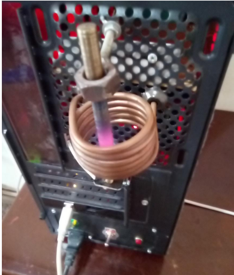
Figura 65. Templado superficial de la barra de acero de 8[mm] de diámetro
