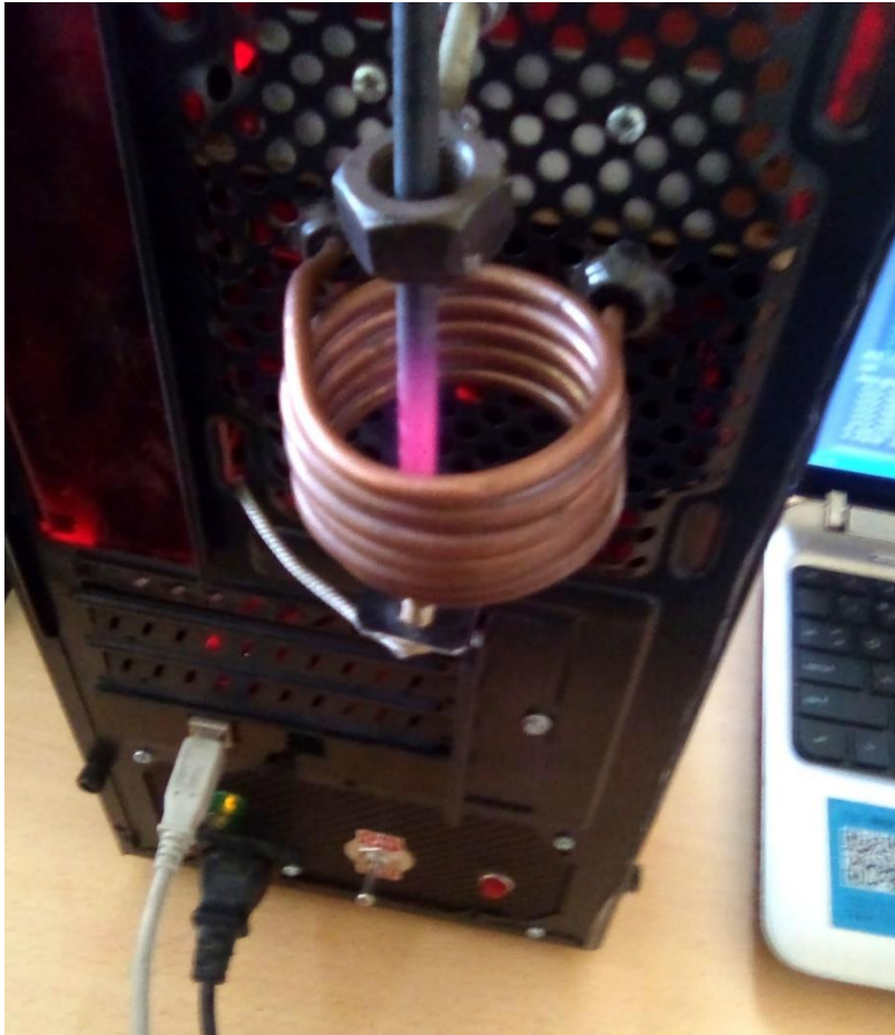
Figura 63. Temple total de la barra cilíndrica de acero de 5[mm] de diámetro
