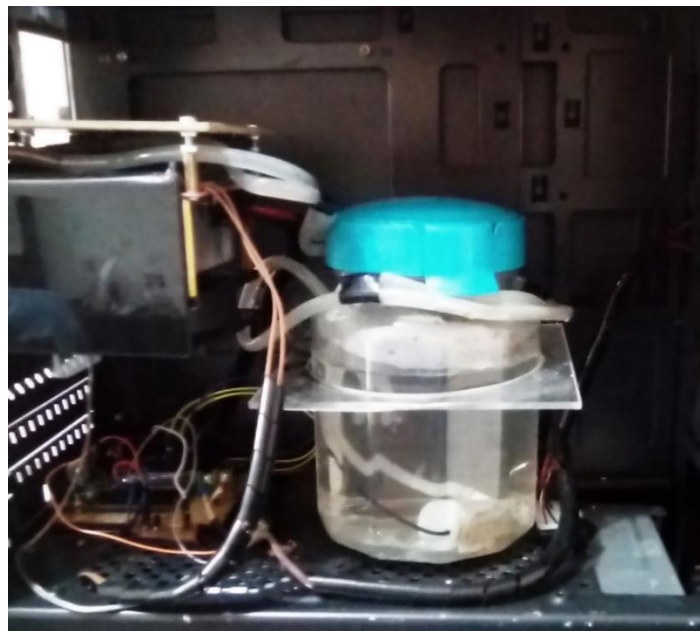
Figura 46. Equipo de refrigeración para la bobina de inducción
