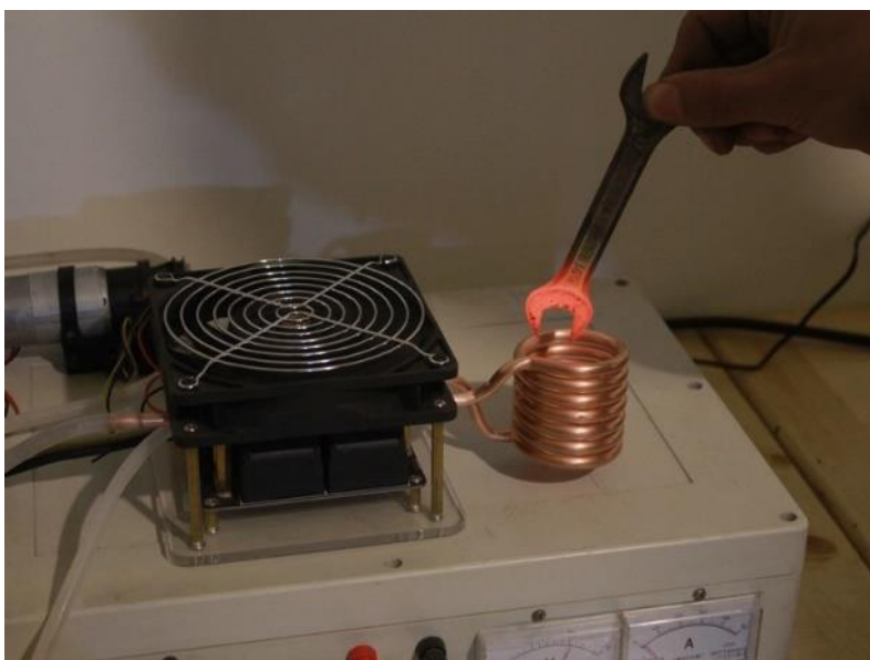
Figura 1. Temple por inducción o calentamiento por inducción electromagnética Fuente: (AliExpress, 2018)
