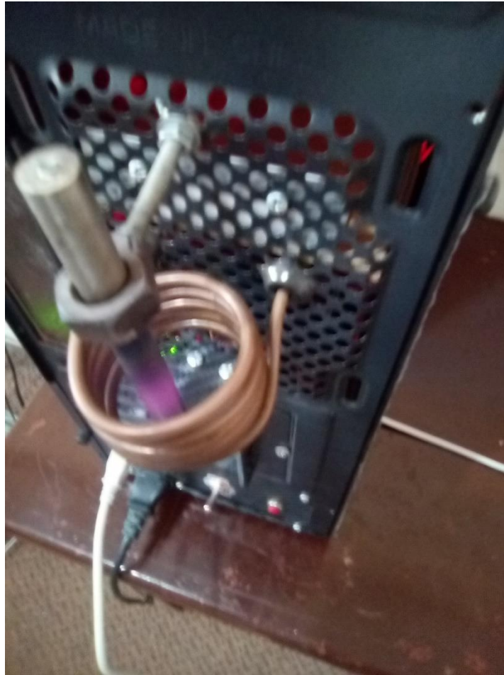
Figura 67. Templado superficial para la barra de acero de 10[mm] de diámetro
