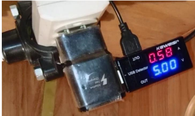
Figura 62. Corriente del servo al mover 1 kg
