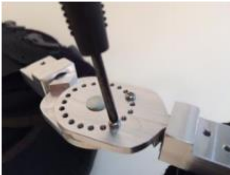
Figura 9. Bisagra para ajustar el rango de movimiento Fuente: (Caerus Corp, 2016)
