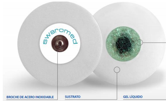
Figura 19. Estructura del electrodo de cloruro de plata (Al, Monitoreo, & Latinoamérica, s/f)
