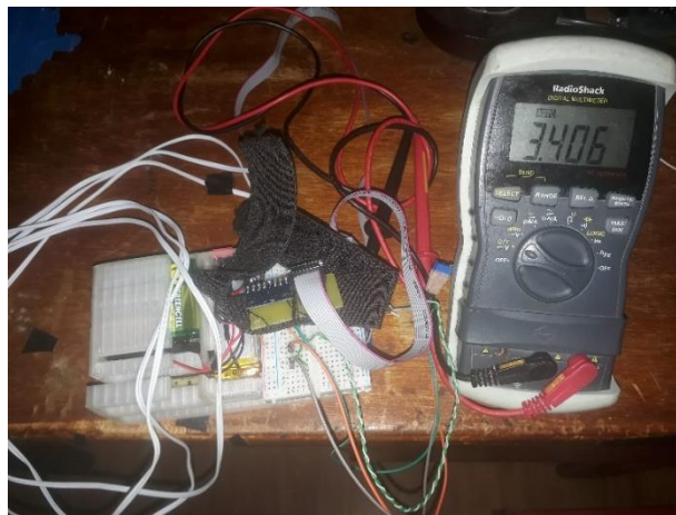
Figura 77. Comprobación de la carga mínima de la batería lipo
