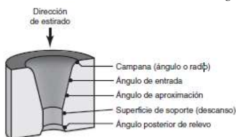
Figura 9. Terminología de un dado para trefilado
