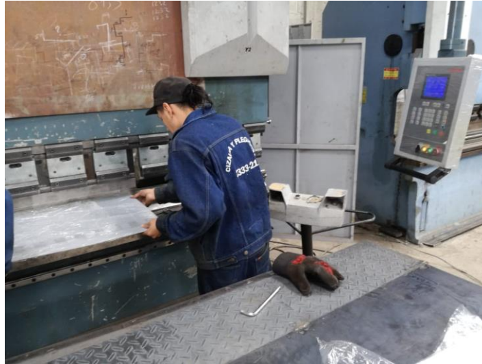
Figura 123. Doblado de pizas de aluminio anodizado en dobladora hidráulica
