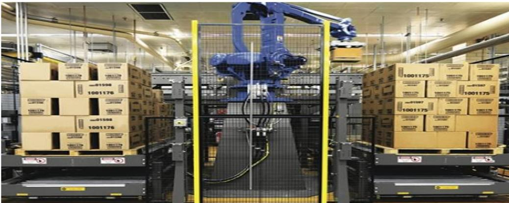
**Figura 9.** Brazo robótico encargado del movimiento de cargas pesadas.
