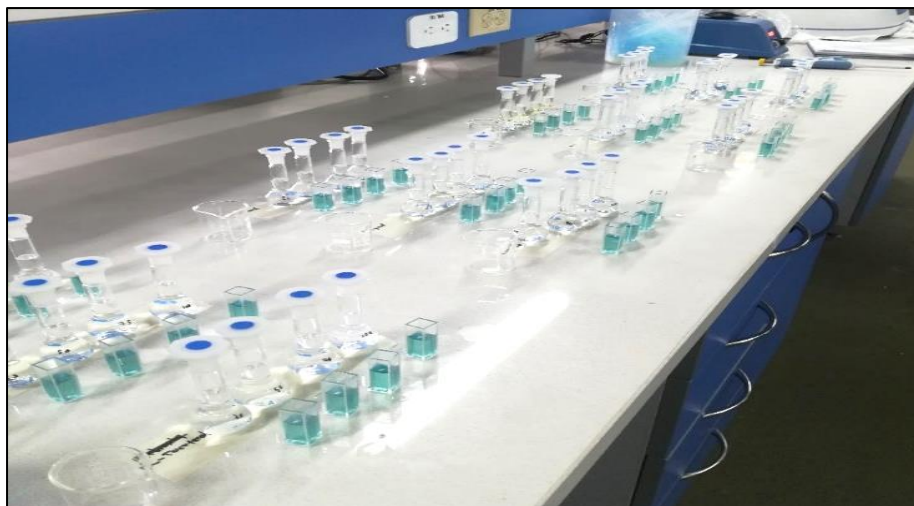
Figura 28. Curvas de calibración preparadas simultáneamente bajo el procedimiento de análisis del método con radical ABTS^{\bullet+} .
