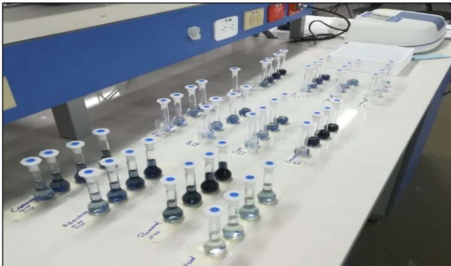
Figura 26. Curvas de calibración preparadas simultáneamente bajo el procedimiento de análisis del método Folin-Ciocalteu.
