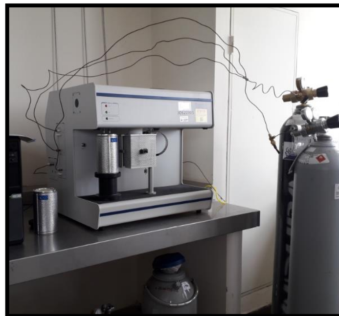
Sistema automático de caracterización de catalizadores
