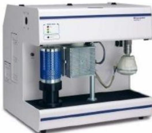
**Figura 18.** Sistema automático de caracterización de catalizadores.
