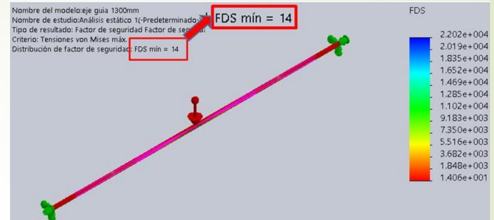
Análisis Factor de seguridad en el eje X
