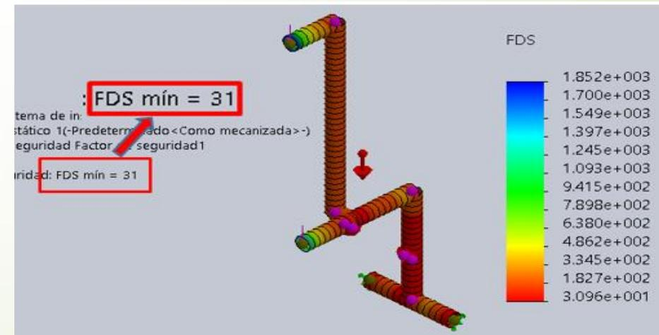
Análisis del factor de diseño del brazo de soporte de inserción
