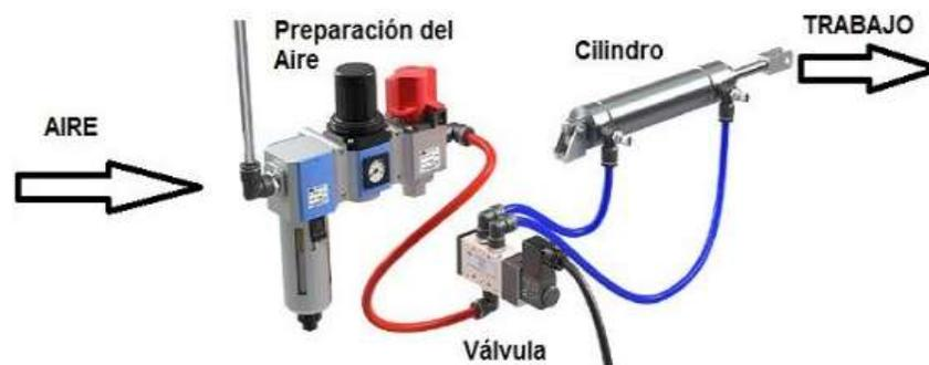
**Figura 7 Circuito neumático**
