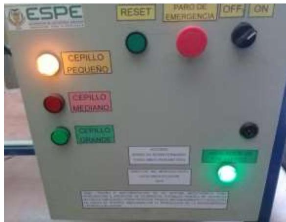
**Figura 139 Luces indicadoras del tablero de control**
