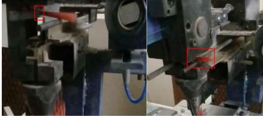
**Figura 142 Transporte de las cerdas flexibles hacia el insertador**
