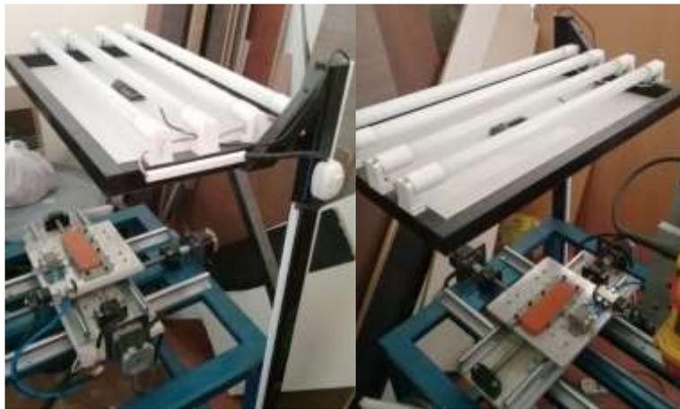
**Figura 112 Ensamble de la estructura de visión en la mesa base**
