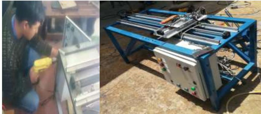
**Figura 111** Ensamble de la caja de control en la mesa base
