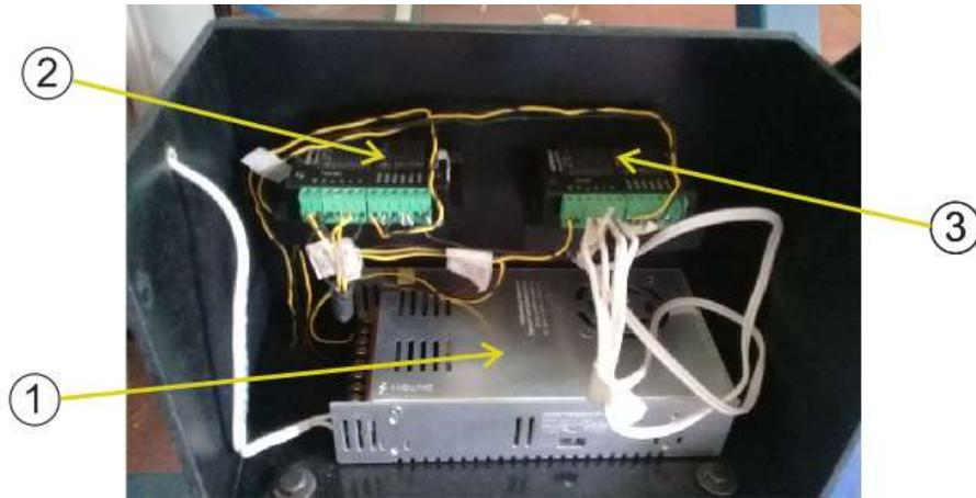
**Figura 124 Conexión de motores, drivers, fuente de poder (X e Y)**
