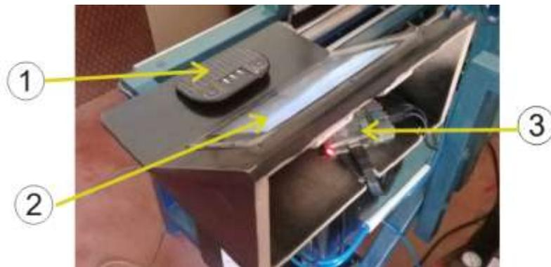
**Figura 127 Conexiones de la pantalla con la tarjeta Raspberry Pi 3**
