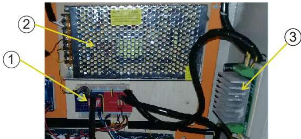
**Figura 125 Conexión de motores, drivers, fuente de poder (Z y Alambre)**
