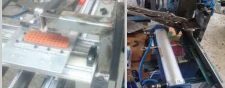
Se ensambla la estructura que sirve como dosificador de cerdas flexibles y se la ubica en la parte superior de la contraguía.
