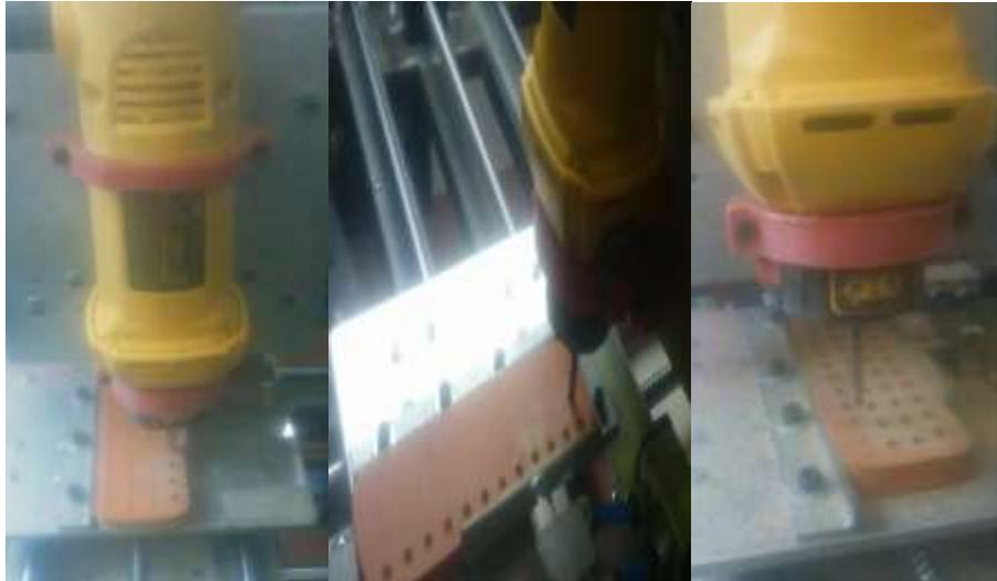
**Figura 140** Proceso de perforación de la matriz base
