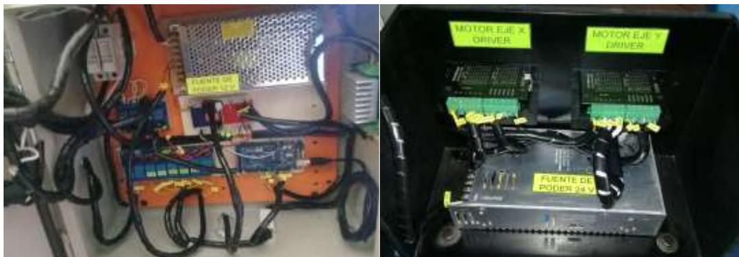
**Figura 133 Etiquetado de las conexiones**
