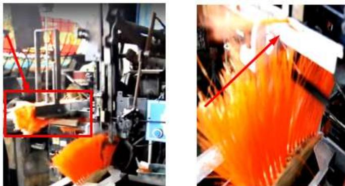
**Figura 26 Dosificador lineal por gravedad**
