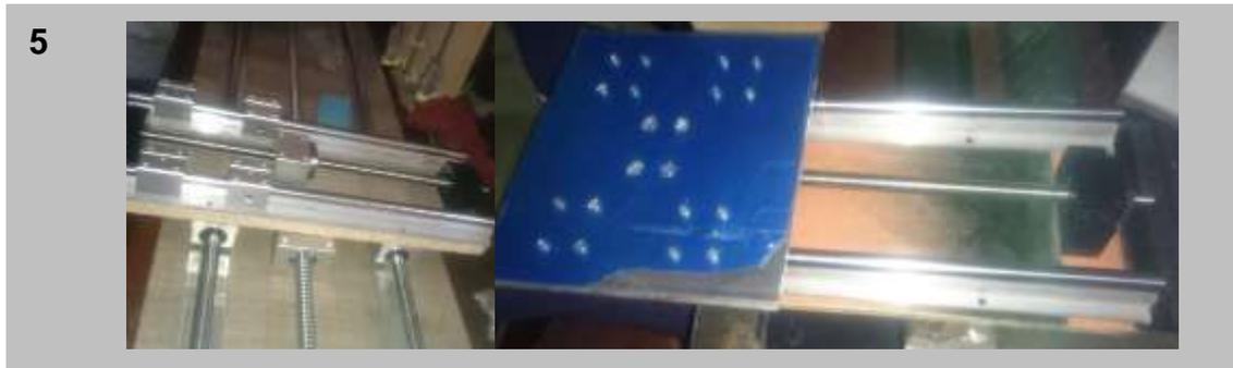
En la Figura 110 se puede observar el ensamble completo del sistema de movimiento de la mesa superior e inferior sobre la mesa base con todos sus componentes que lo conforman.
