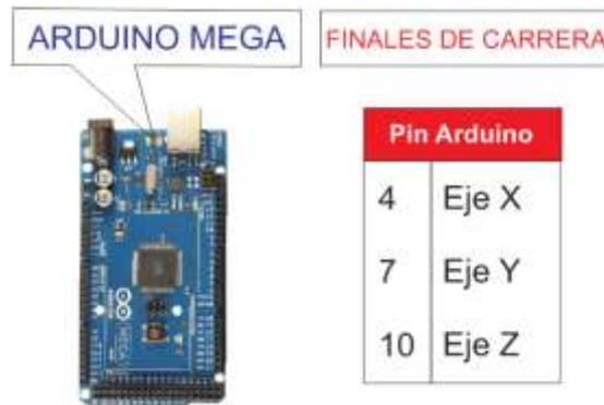
**Figura 99 Pines Arduino Mega – Finales de carrera**
