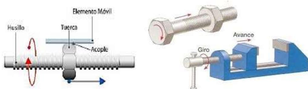
**Figura 17 Tornillo de Potencia**
