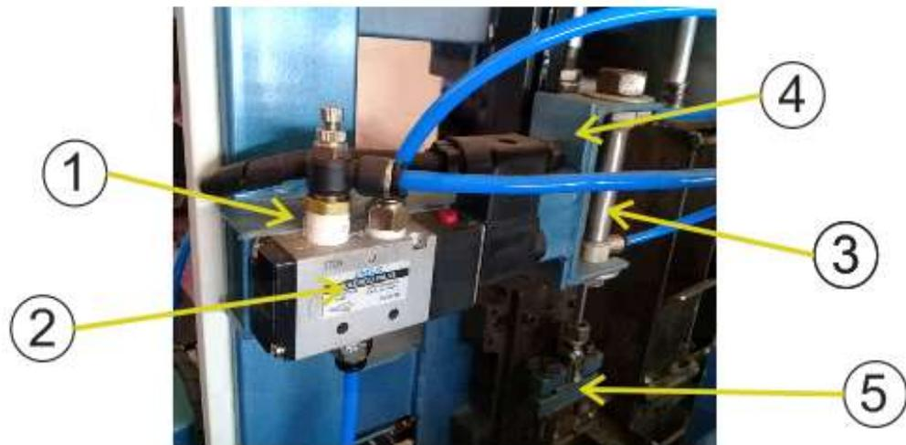
**Figura 117 Actuador del cortador de la matriz de inserción**
