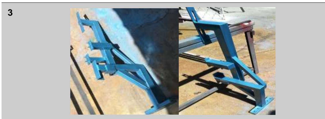
Con el brazo de soporte ya ensamblado se lo acopla a la mesa base como el tercer proceso de la máquina y a su vez se ubican todos los componentes neumáticos como son las electroválvulas, los cilindros y las mangueras de aire. También se ubica la matriz de inserción y sus partes acopladas a cada actuador neumático. Las figuras siguientes muestran el brazo ensamblado completamente con todos sus componentes, así como también la prueba funcional de cada actuador neumático.
