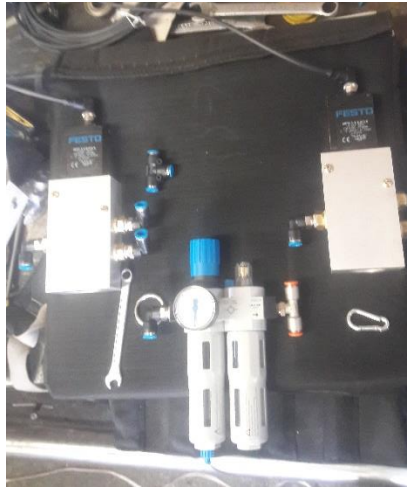
Figura 63. Sujeción de elementos neumáticos en el espaldar
