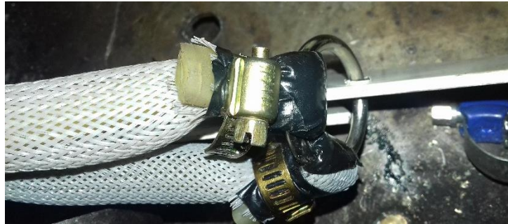
Figura 56. Par de músculos McKibben en aro de 1'' sobre el antebrazo
