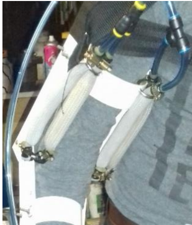
Figura 58. Músculos artificiales del bíceps derecho-instalados
