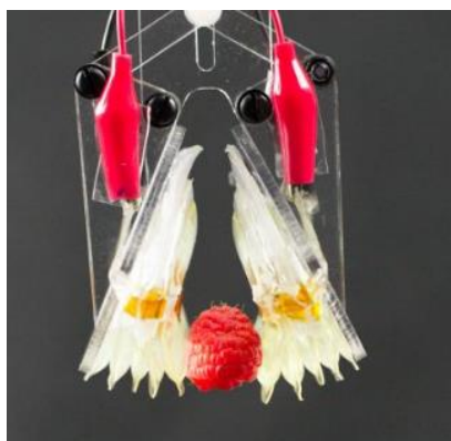
Figura 5. Músculo artificial activado eléctricamente
