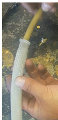
Figura 50. Ingreso de manguera LATEX en la malla trenzada
