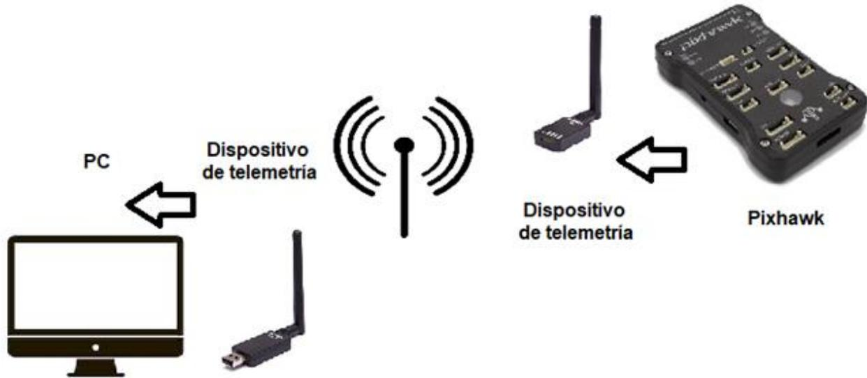
**Figura 39.** Esquema de conexión entre la computadora y la tarjeta APM.
