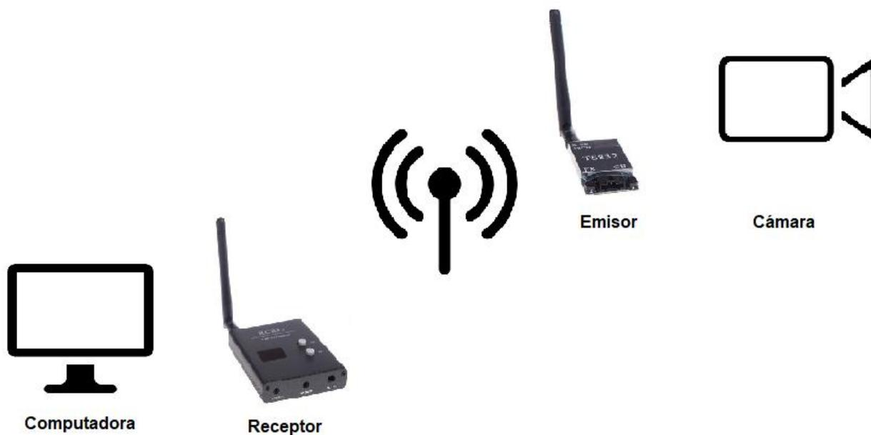
**Figura 55.** Esquema simbólico de conexión entre la cámara y el ordenador en tierra
