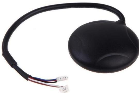
**Figura 33.** Módulo GPS Neo 6M
