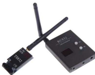
**Figura 53. Módulo transmisor y receptor RC832 inalámbrico**
