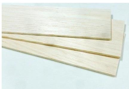
**Figura 8.** Planchas de madera de balsa
