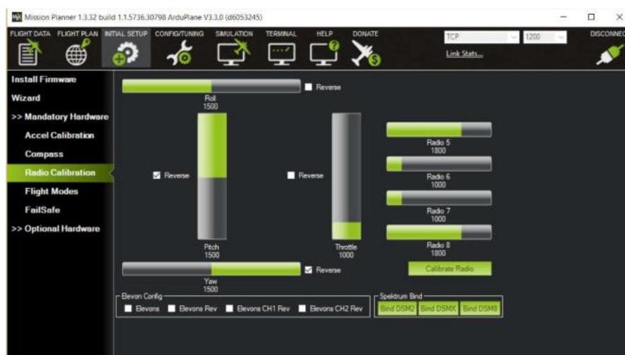
**Figura 46.** Pantalla de Calibración de Radio
